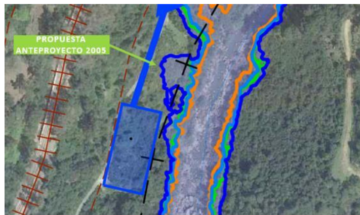
Ilustración 26. Ubicación de Alternativa 2 con respecto a Anteproyecto 2005 y zona inundable río Guadiaro (Fuente: Elaboración propia)
