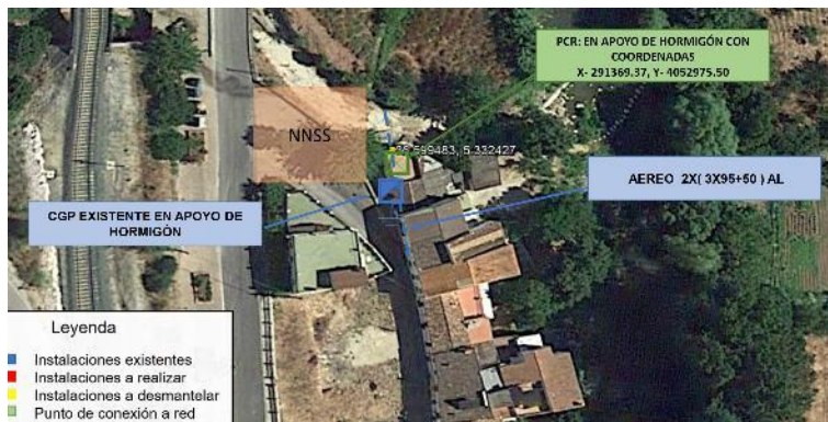
Punto de Conexión en Baja Tensión para suministro a la EBAR.
