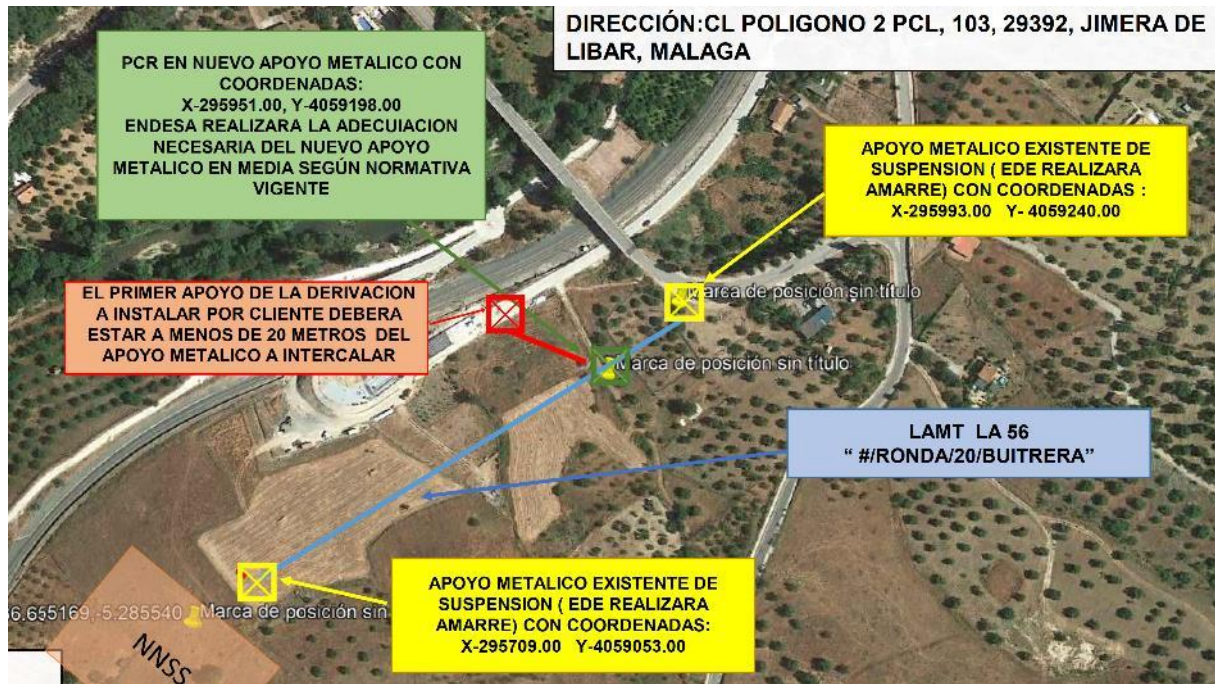
Nueva línea aérea de Media Tensión para suministro a la EDAR.
