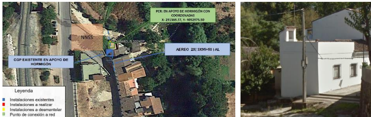
Ilustración 47. Punto de Conexión en Baja Tensión para suministro a la EBAR
