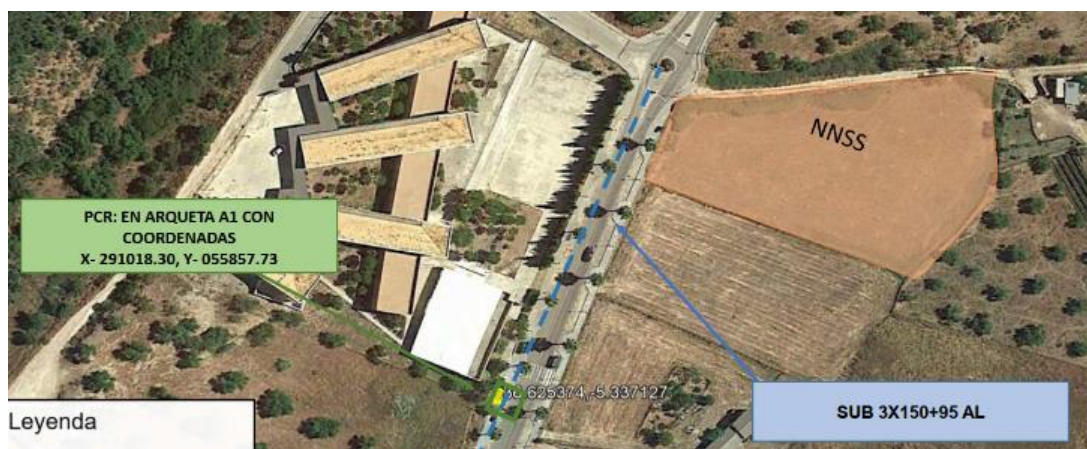
Ilustración 44. Punto de Conexión en Baja Tensión para suministro a la EBAR
