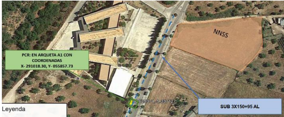
Punto de Conexión en Baja Tensión para suministro a la EBAR.
