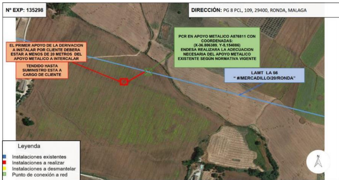
Punto de Conexión en Media Tensión para suministro a la EDAR.
