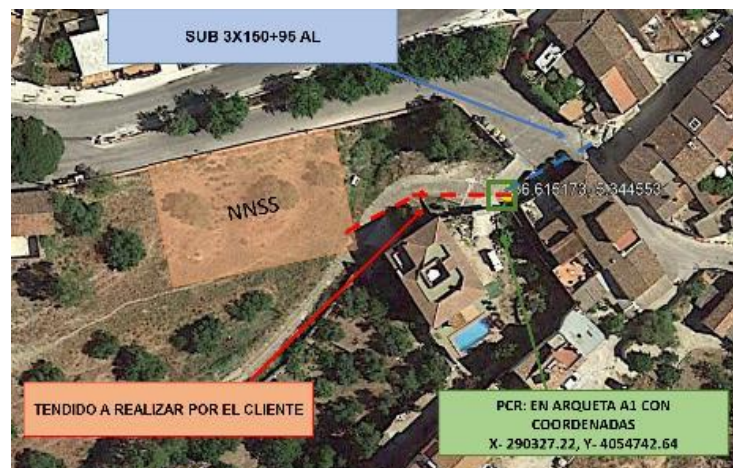
Ilustración 46. Punto de Conexión en Baja Tensión para suministro a la EBAR
