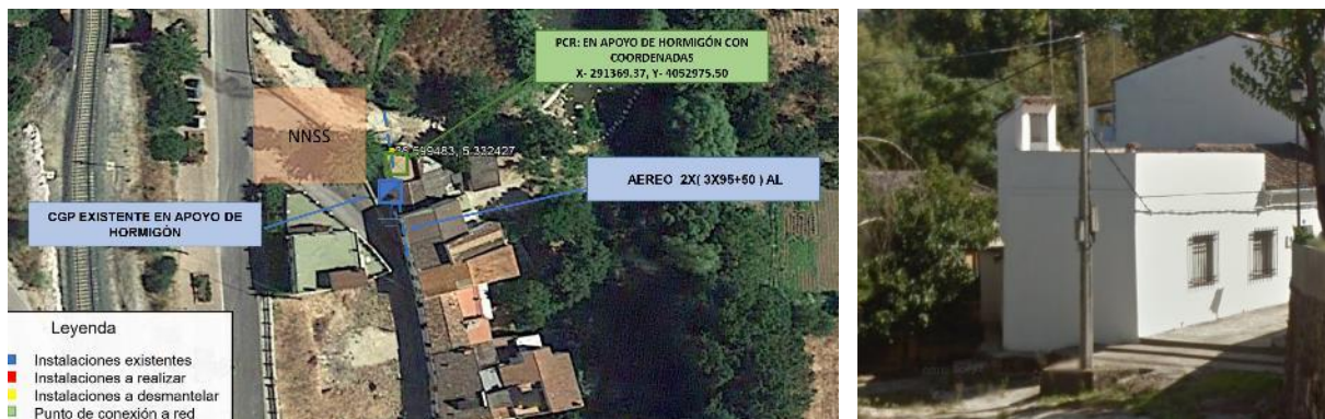
Punto de Conexión en Baja Tensión para suministro a la EBAR.
