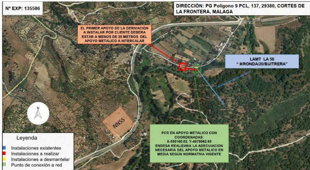
Nueva línea aérea de Media Tensión para suministro a la EDAR.
