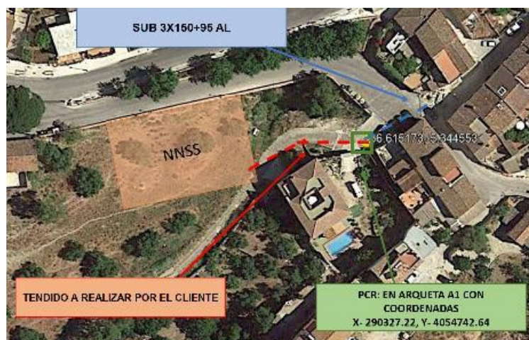
Punto de Conexión en Baja Tensión para suministro a la EBAR.
