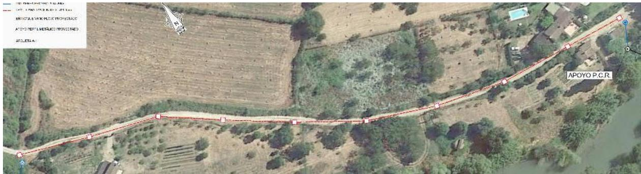
Próximo a la última arqueta del tramo soterrado, se instalará un apoyo principal de línea. A partir de dicho apoyo se realiza un tramo aéreo hasta las inmediaciones del Centro de Transformación de la EDAR, dispondrá de una longitud aproximada de 610 metros. En total, se implantarán 6 nuevos apoyos.
