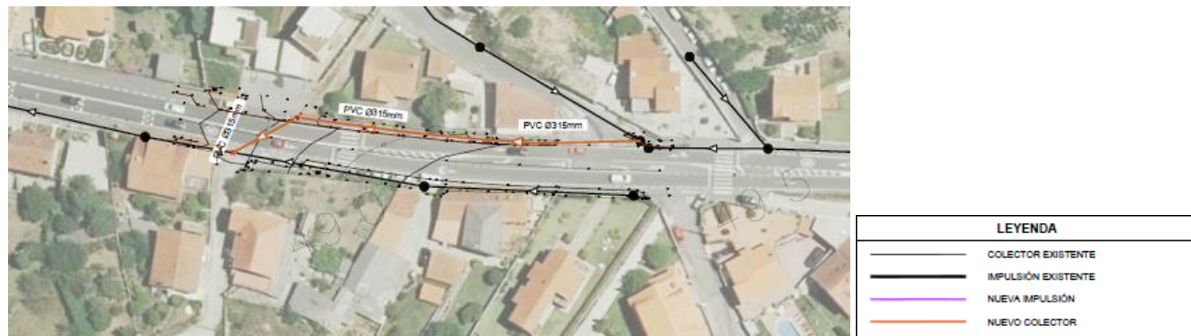
Figura 3 Trazado del colector de A Costa, con cruce bajo la PO-308 ejecutado con perforación horizontal dirigida
