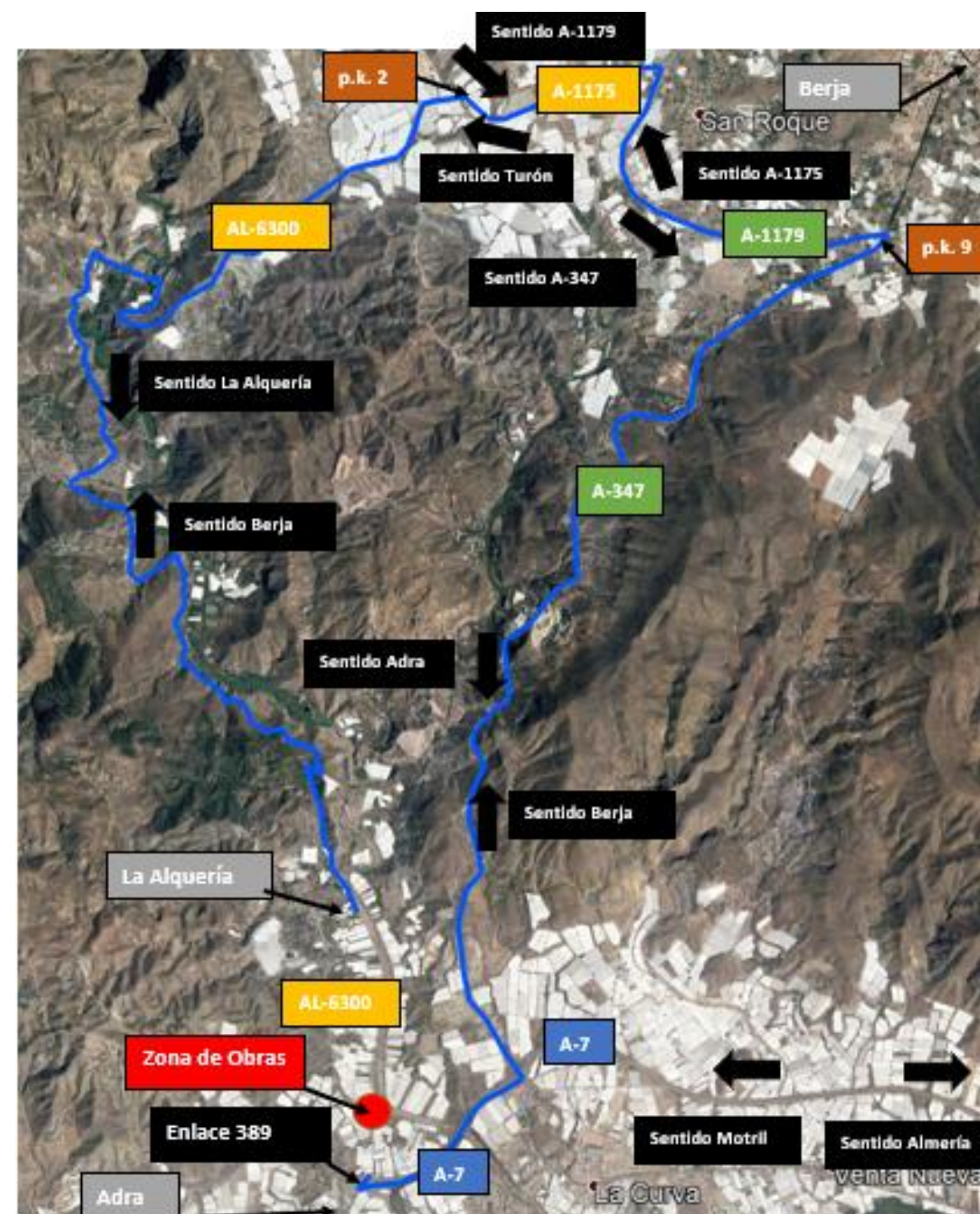
Figura 4. Ilustración 1. Propuesta de itinerario alternativo durante la ejecución de las obras
