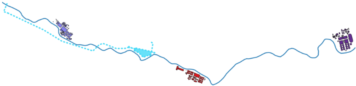
Ilustración 8. Esquema de la ubicación de las EDAR, el tanque de tormentas y el colector de pluviales (línea discontinua azul claro) respecto al río Manzanares (línea continua de color azul oscuro) en la alternativa 4 MD TTU2
