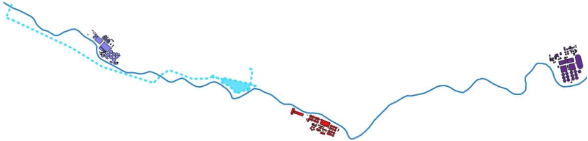
Ilustración 9. Esquema de la ubicación de las EDAR, el tanque de tormentas y el colector de pluviales (línea discontinua azul claro) respecto al río Manzanares (línea continua de color azul oscuro) en la alternativa 4 MD TTU2
