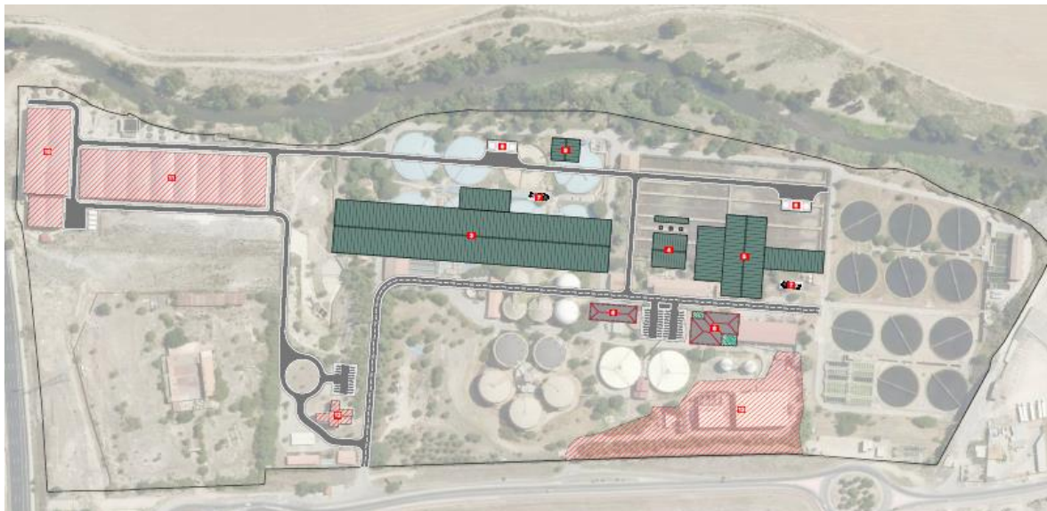
Ilustración 98. Esquema de propuesta de EDAR Butarque renovada en la alternativa 12
