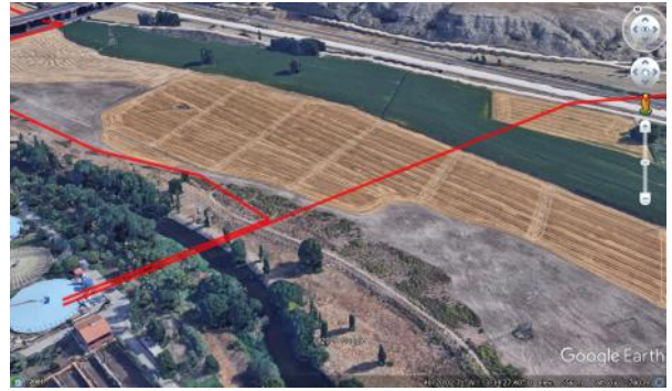
Ilustración 79. Inicio de la impulsión subterránea de fangos hacia EDAR Sur. Cruce aéreo del río Manzanares
