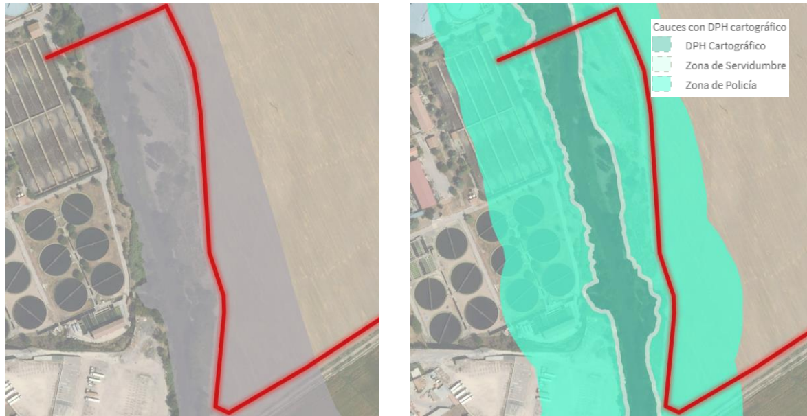
Ilustración 13. Canalización del bombeo de fangos a Sur. Cruce del cauce. ZFP (izquierda). DPHc (derecha)
