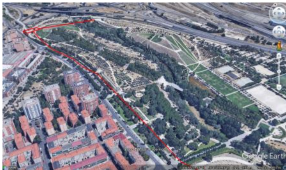
Ilustración 117. Vista del tramo de colector por margen derecha desde arqueta de figura anterior y atravesando el Parque existente por un vial
