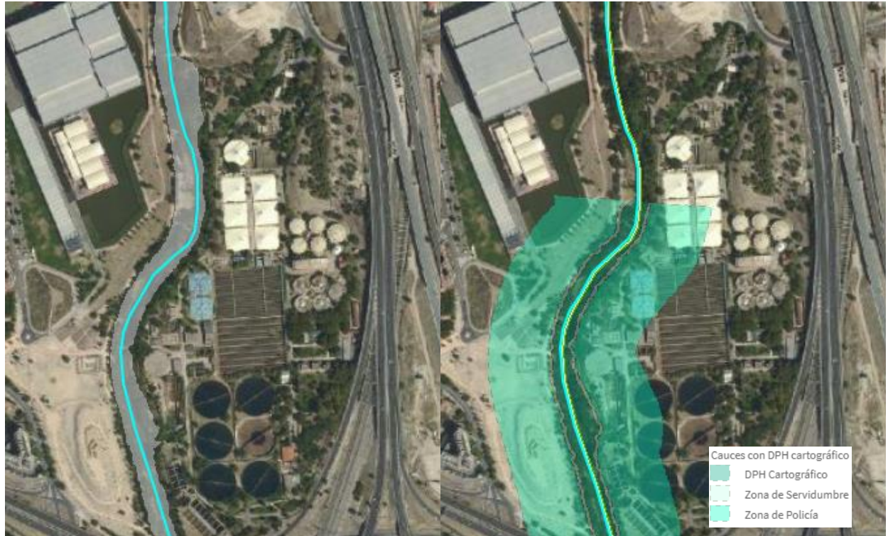
Ilustración 2. EDAR La China actual. Zona de Flujo Preferente (izquierda). Dominio Público Hidráulico Cartográfico (derecha)
