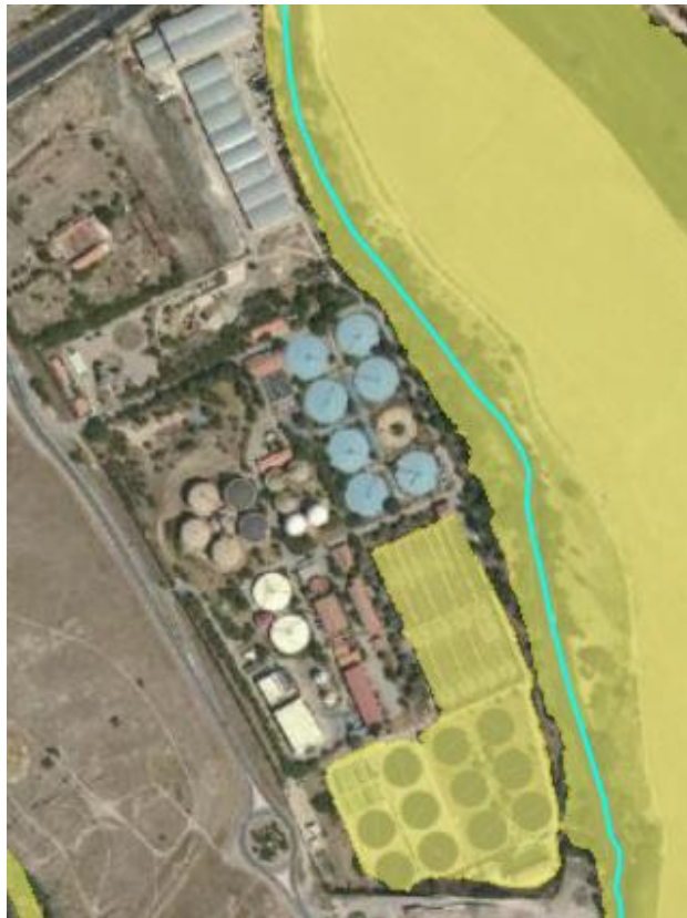
Ilustración 7. EDAR Butarque actual. Zona de inundación con probabilidad baja o excepcional (T=500 años)
