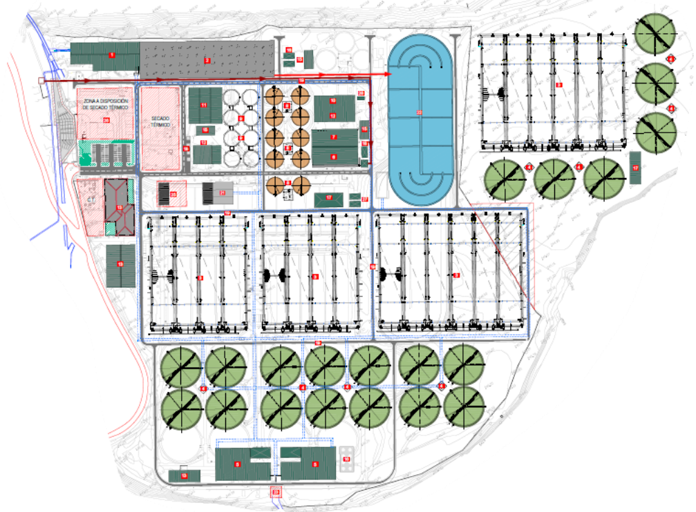
Ilustración 14. Esquema de propuesta inicial de EDAR Sur renovada en la alternativa 12
