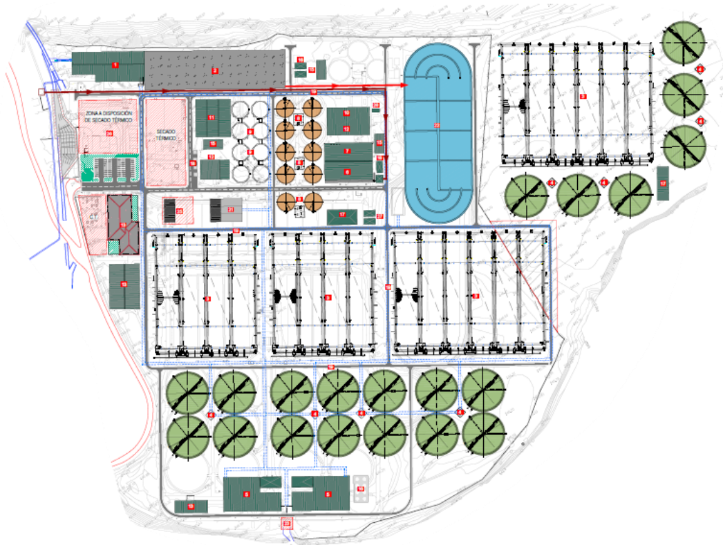
Ilustración 99. Esquema de propuesta inicial de EDAR Sur renovada en la alternativa 12
