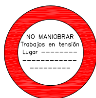
NO MANIOBRAR TRABAJOS EN TENSION
