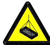
RIESGO CARGAS SUSPENDIDAS
