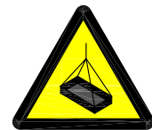
RIESGO CARGAS SUSPENDIDAS
