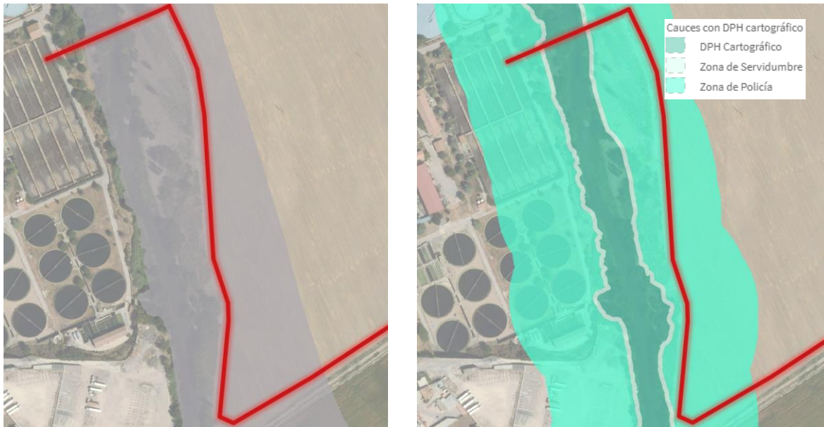
Ilustración 7. Canalización del bombeo de fangos a Sur. Cruce del cauce. ZFP (izquierda). DPHc (derecha)
