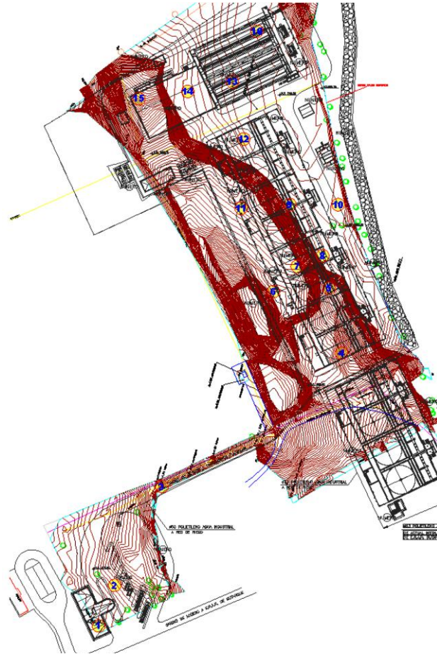
Penetrómetros realizados en la parcela de la ERAR Butarque para el nuevo pretratamiento
