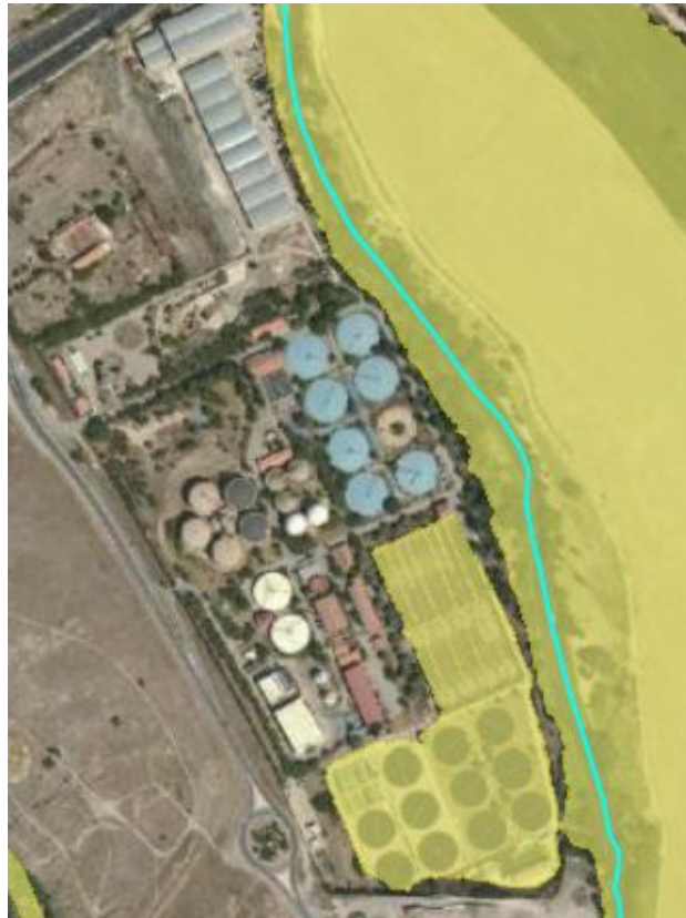
Ilustración 1. EDAR Butarque actual. Zona de inundación con probabilidad baja o excepcional (T=500 años)
