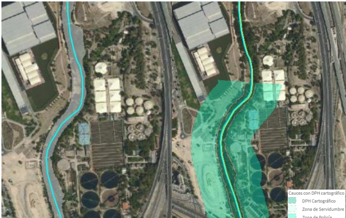
Ilustración 2. EDAR La China actual. Zona de Flujo Preferente (izquierda). Dominio Público Hidráulico Cartográfico (derecha)
