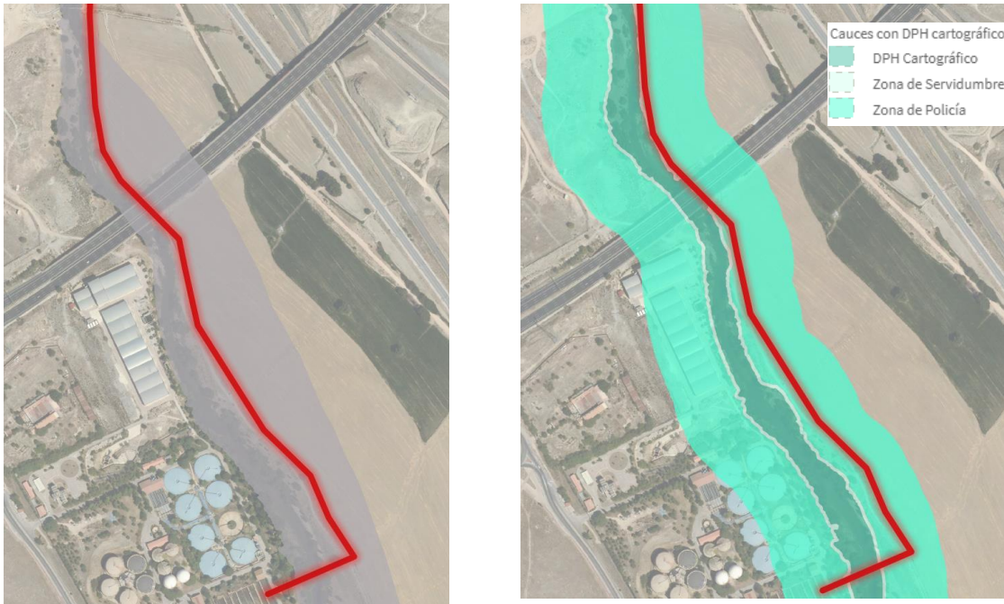
Ilustración 5. Canalización del bombeo de fangos a Butarque. ZFP (izquierda). DPHc (derecha)
