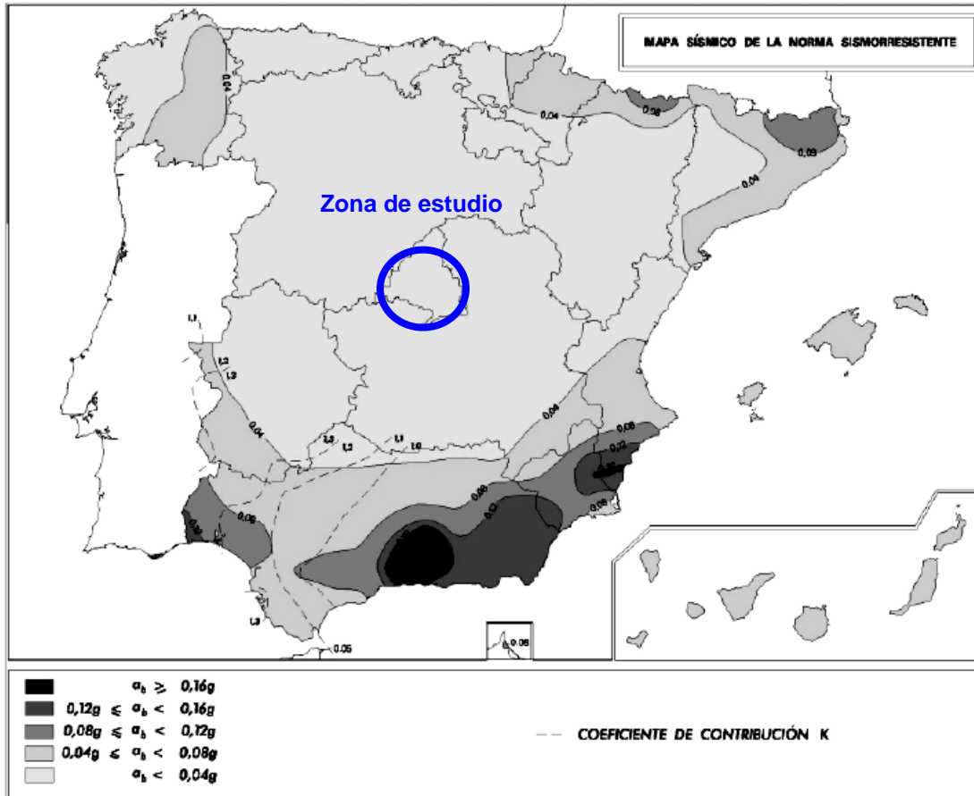
Mapa de peligrosidad sísmica en España para un período de retorno de 500 años (NCSE-02).
