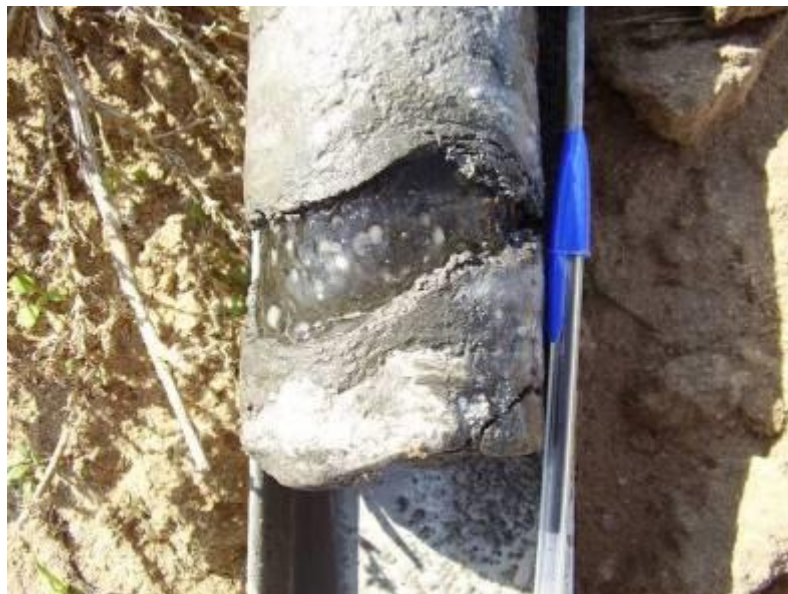
Detalle de disolución localizada sobre los yesos.
