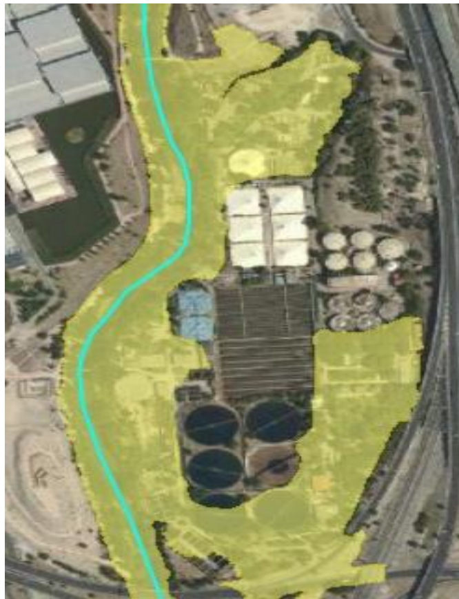
Ilustración 1. EDAR La China actual, zona de inundación con probabilidad baja o excepcional (T=500 años)
