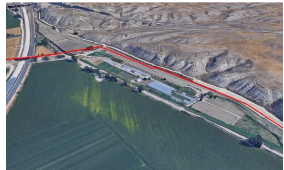
Ilustración 140. La impulsión subterránea continua adyacente al camino existente dirección a la EDAR Sur
