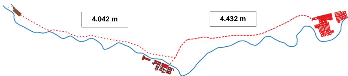
Ilustración 20. Esquema de la ubicación de las EDAR y la impulsión de fangos respecto al río Manzanares (línea continua de color azul) en la alternativa 2
