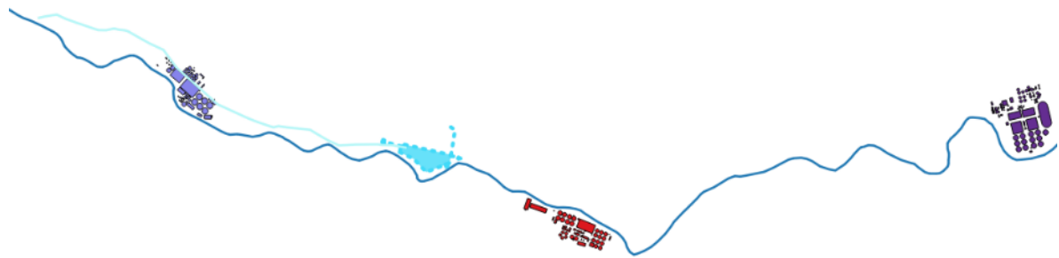
Ilustración 25. Esquema de la ubicación de las EDAR, el tanque de tormentas y el colector de pluviales (línea continua azul claro) respecto al río Manzanares (línea continua de color azul oscuro) en la alternativa 3 MI TTU2
