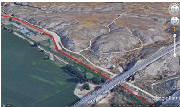
Ilustración 141. Impulsión subterránea cruzando LAV y M-50. Colindante al Canal del Manzanares
