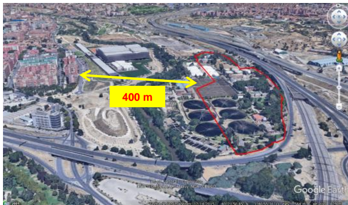
Ilustración 120. Nuevo contorno que ocupa la EDAR La China renovada en las alternativas 2, 3 y 4. Y distancia de separación de los edificios residenciales, ampliada de 200 a 400 m
