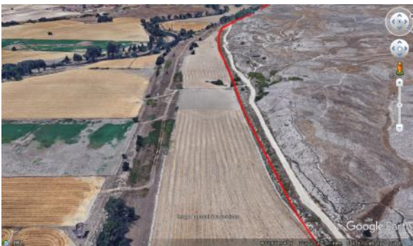
Ilustración 144. Impulsión subterránea junto a talud de camino existente
