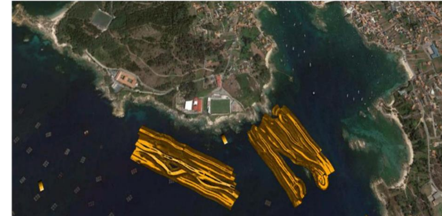
Imagen 85. Mosaico con cobertura total a partir de los datos obtenidos con el sonar de barrido lateral en la zona de estudio.
