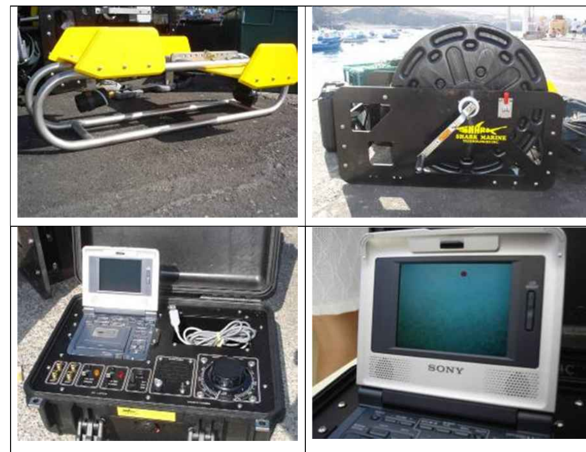
Figura 6.- Imágenes del equipo de filmación Sea View Diving de SHARK MARINE.
