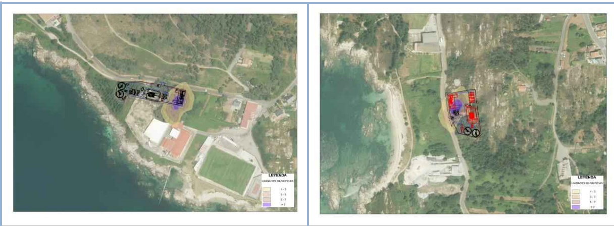
Ilustración 20. Mapa odorífero para las dos alternativas de implantación considerada con un caudal de 15.000 m 3 /h y 300 uoE/m 3 (correcto funcionamiento del sistema de desodorización).
