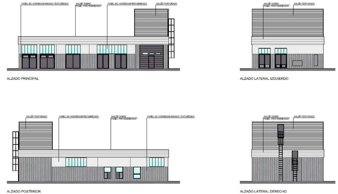
Ilustración 20 Edificio de deshidratación.
