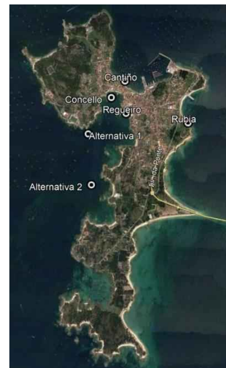
Ilustración 3. Localización de las ubicaciones del vertido continuo de la EDAR en los escenarios 1 y 2 (Alternativa 1) y en el escenario 3 (Alternativa 2), así como de los aliviaderos del sistema de saneamiento (Rubia, Cantillo, Praza do Regueiro y Concello).
