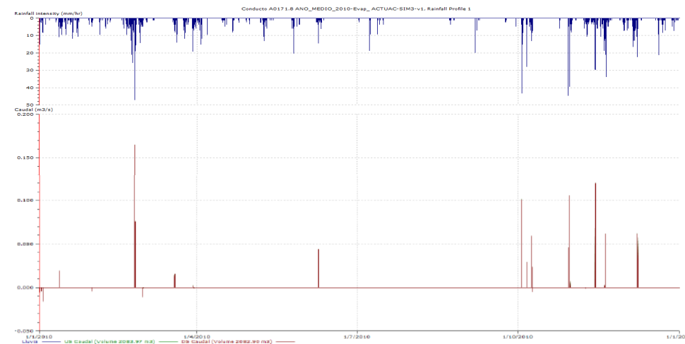
Ilustración 6. Alivios en bombeo de Porto Cantiño (volumen 2.083 m3/año; 13 alivios). Simulación 3
