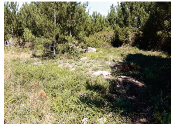
Múltiples afloramientos de granodiorita alterada en grado II-I en la zona donde se proyecta la ubicación del decantador secundario Sur.
