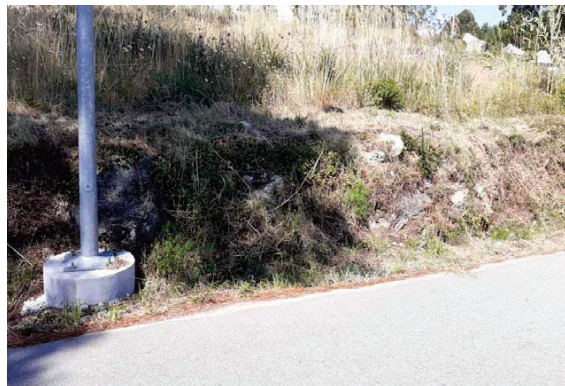
Afloramiento rocoso sin recubrimiento superficial de suelo vegetal, en zona por donde discurrirá la canalización de impulsión. Granodiorita alterada en grado II con continuidad lateral.
