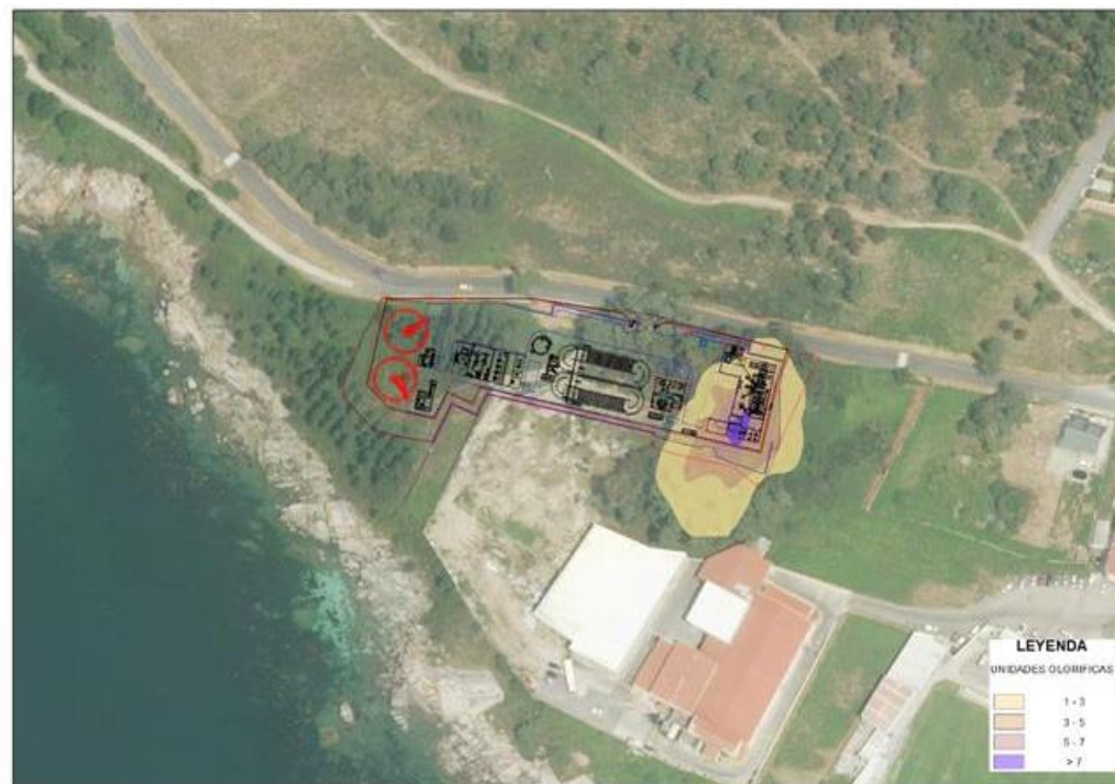
Imagen 34. Resultados Emisión 300 uoE/m 3 chimenea orientada 315° N y 45° de inclinación – Resultado: < 5 uoE/m 3 en límite de parcela
