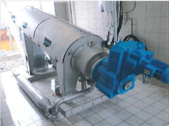
Imagen 43. Prensa de tornillo.
