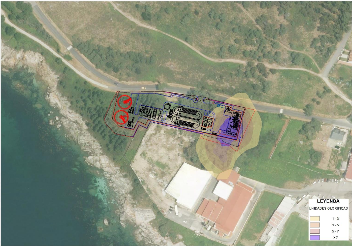
Ilustración 10. Resultados Emisión 300 uoE/m³ chimenea vertical – Resultado: > 5 uoE/m³ en límite de parcela
