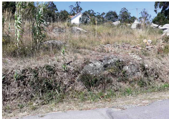
Afloramiento rocoso sin recubrimiento superficial de suelo vegetal, en zona por donde discurrirá la canalización de impulsión. Granodiorita alterada en grado III-II con continuidad lateral.
