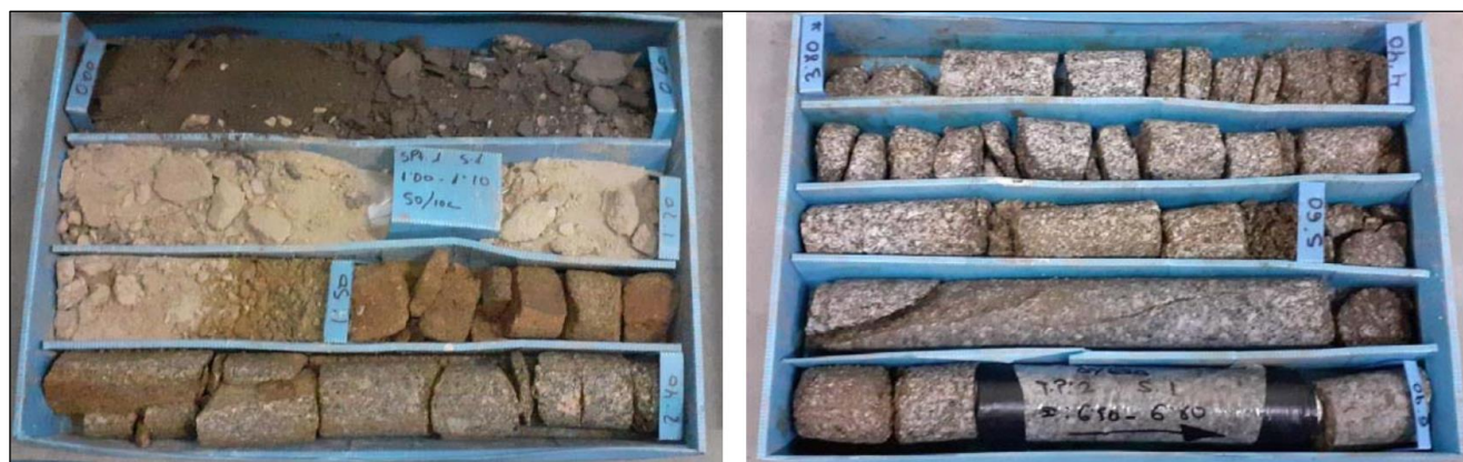
Imagen 3: Secuencia litológica identificada en las maniobras de sondeo. Nivel de tierra vegetal, jabre granítico arenoso y unidad de granodioritas con diferentes grados de alteración
