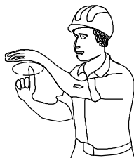
11 GIRAR EL AGUILON EN LA DIRECCION INDICADA POR EL DEDO
