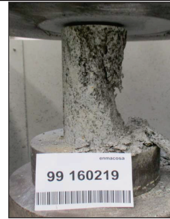
Foto N°1 Vista del testigo después de la rotura
