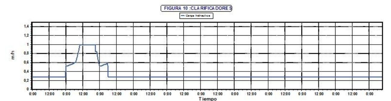
Imagen 20: Carga hidráulica en decantadores secundarios en simulación.
