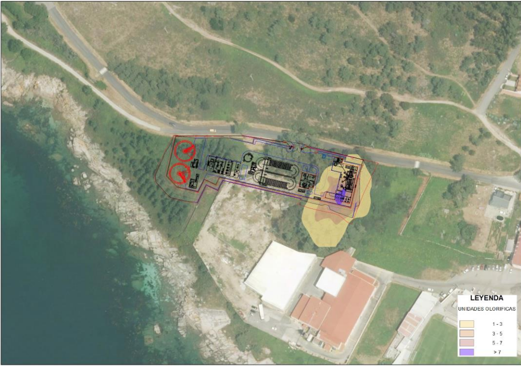
Ilustración 11. Resultados Emisión 300 uoE/m³ chimenea orientada 315° N y 45° de inclinación – Resultado: < 5 uoE/m³ en límite de parcela
