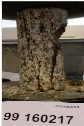
Foto N°1 Vista del testigo después de la rotura
