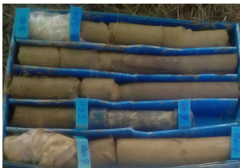
Imagen 8 . Margas perforadas en el sondeo S-1 realizado en la parcela de la EDAR.
