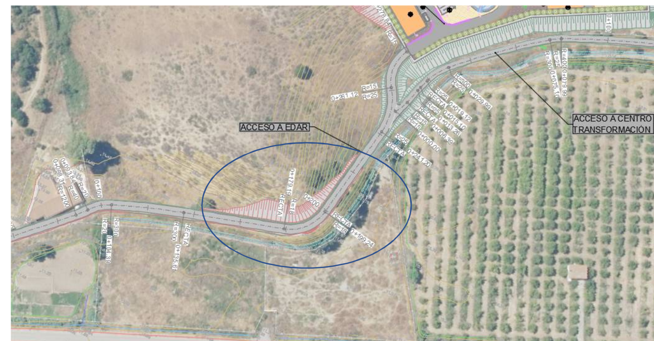
Figura 5. Desmonte camino acceso EDAR.
