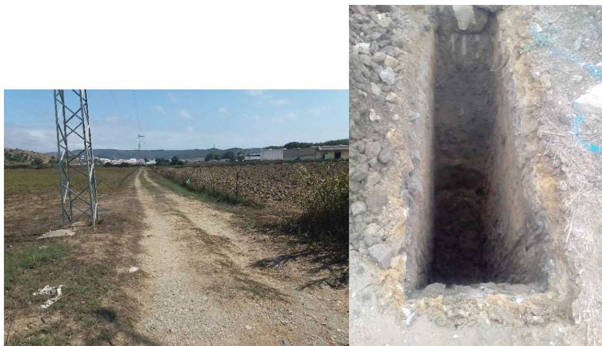
Fotografía 1.y 2. Aspecto de los materiales aluviales en el entorno de la calicata C-6 y zanja de excavación de la C-5.
