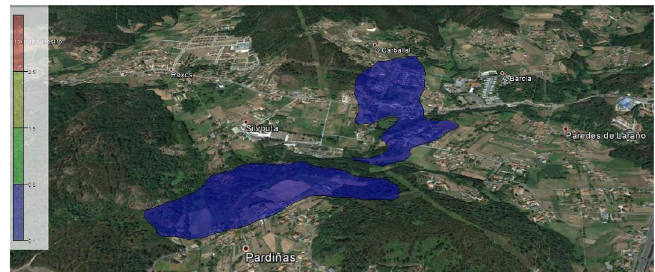
Figura 5.2.5.2. Modelización de la futura EDAR Silvouta. Isodoras 0,10, 0,5, 1,5 y 2,5 uoE/m³ percentil 98. Representación sobre ortofotografía en 3D.
