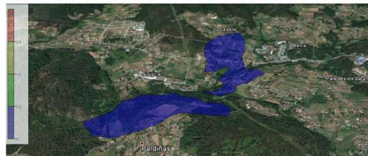
Figura 5.2.5.2. Modelización de la futura EDAR Silvouta. Isodoras 0,10, 0,5, 1,5 y 2,5 uo 2 /m 3 percentil 98. Representación sobre ortofotografía en 3D
