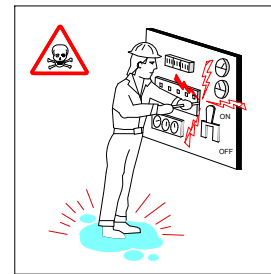
REPARACION DE EQUIPOS BAJO TENSION
