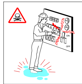
REPARACION DE EQUIPOS BAJO TENSION
