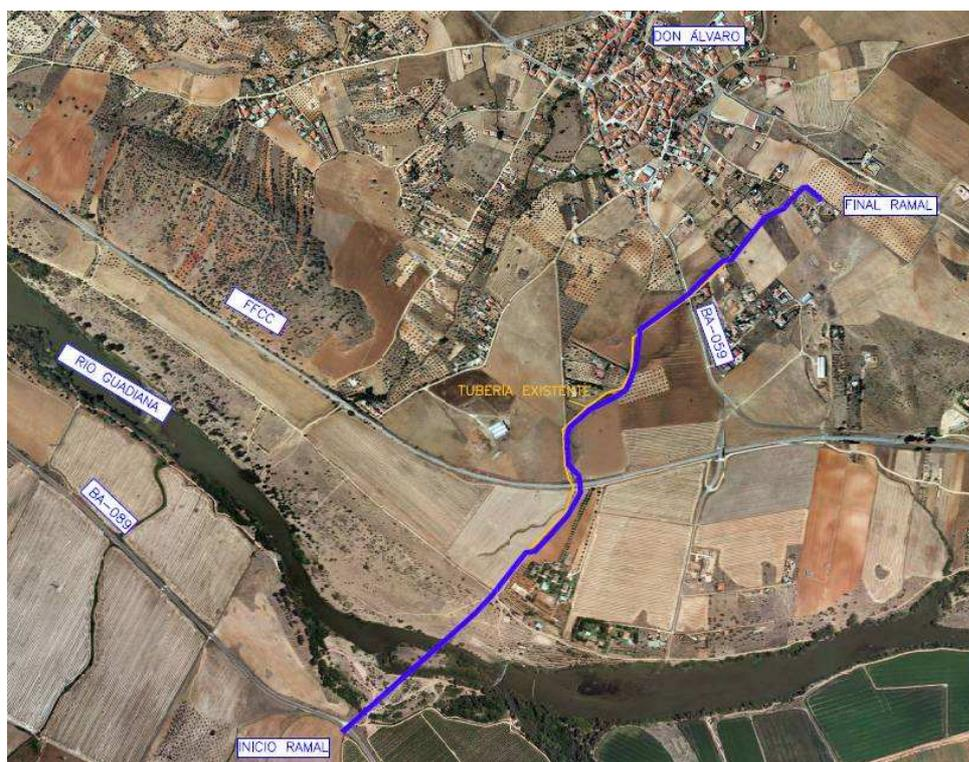
Con el nuevo sistema de abastecimiento a Mérida y la nueva ETAP de Mérida, la antigua tubería de agua bruta de FD 700 mm transportaría ya el agua depurada, y se plantea la conveniencia de reponer la conducción existente hasta Don Álvaro pero ya con las garantías de suministro y calidad que conlleva la nueva infraestructura. Dicha reposición se realiza con tubería de PEAD de Ø200 mm PE100 PN- 16.
