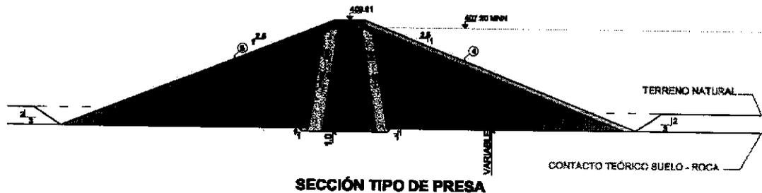
A ambos lados del núcleo se han previsto dos filtros, de tres y cuatro metros de anchura, con el objeto de evitar los arrastres de los materiales del núcleo y evitar también las presiones intersticiales en el espaldón de aguas abajo.
