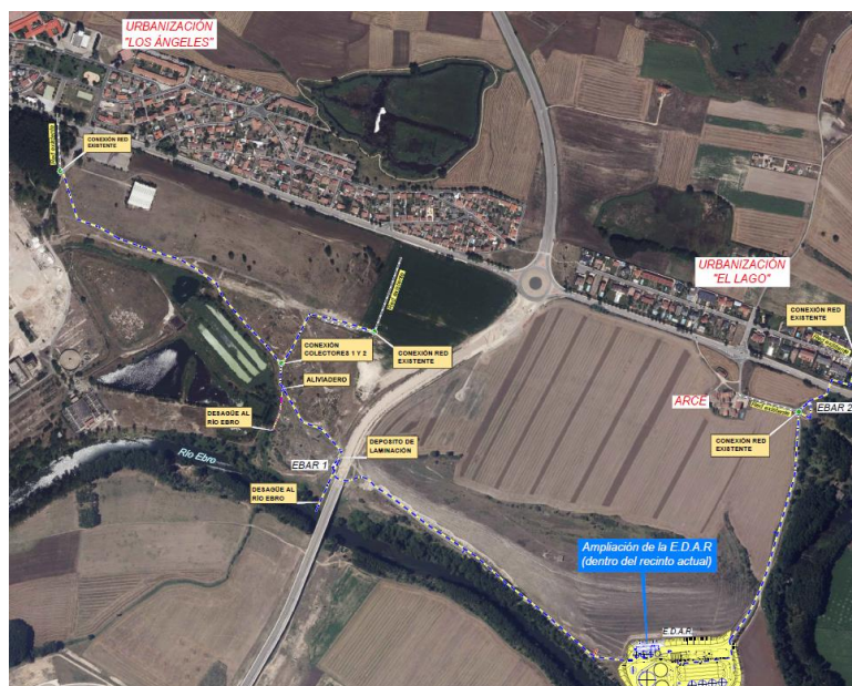
Ilustración 5. Trazado adoptado para conexión de las urbanizaciones de Los Ángeles y El Lago.
