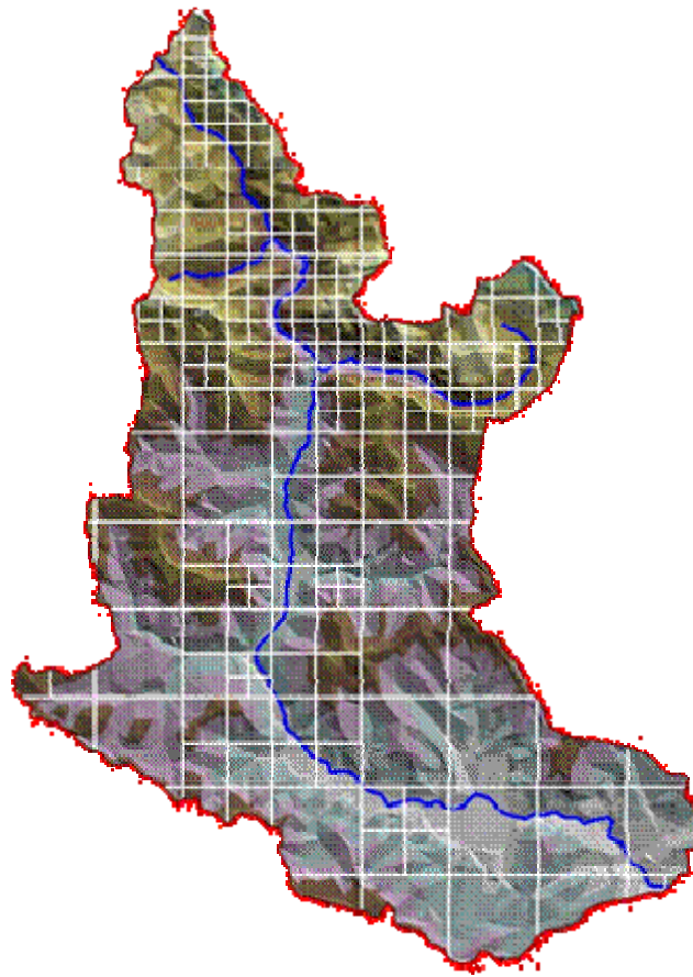
Generación del modelo distribuido a partir del MDT con el modelo ASTER. Cuenca del río Ara
