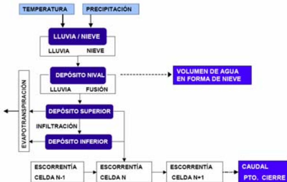
Esquema detallado de la estructura del modelo ASTER
