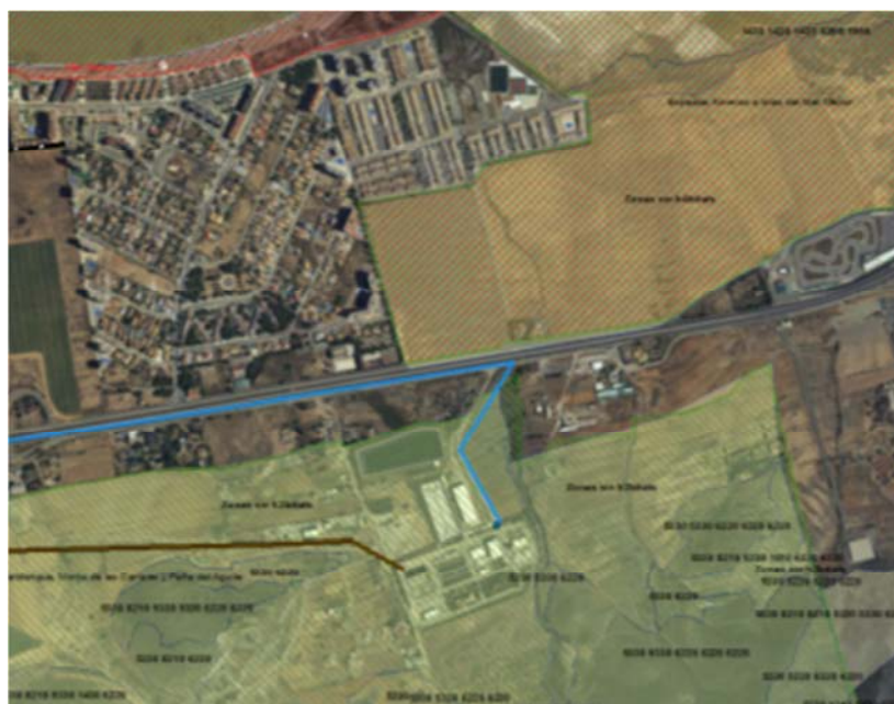
Figura: Detalle del trazado del colector para derivación de los vertidos urbanos y HIC en el LIC “Calblanque, Monte de las Cenizas y Peña del Águila”, en las inmediaciones de la EDAR de Mar Menor Sur.
