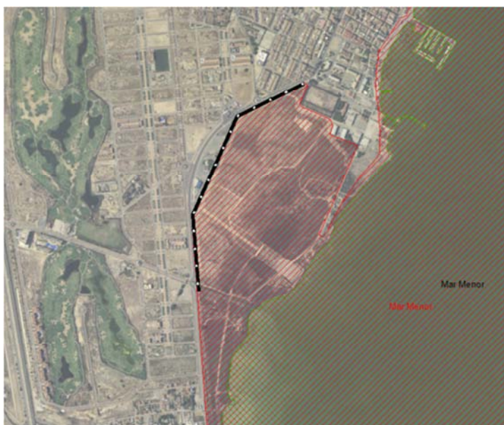
Figura: Trazado de los drenes a ejecutar al Norte de la Rambla del Albuñón en el límite de la ZEPA "Mar Menor".
