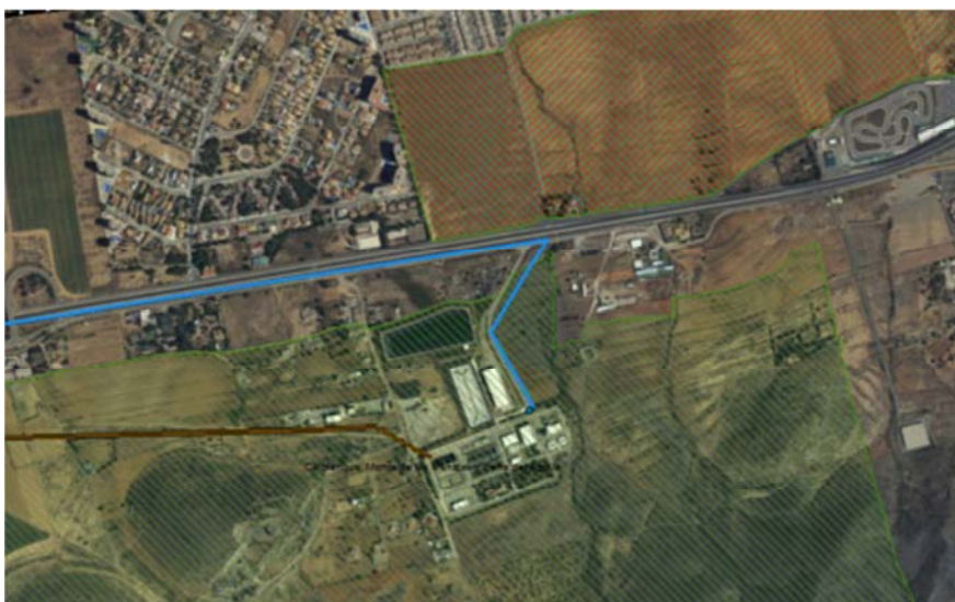
Figura: Trazado del colector de cintura coincidente con el LIC "Calblanque, Monte de las Cenizas y Peña del Águila", en el entorno de la EDAR Mar Menor Sur.
