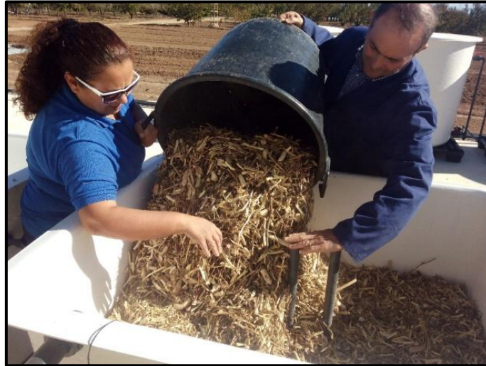
Figura 24. Proceso de llenado de los biorreactores con astillas de madera
