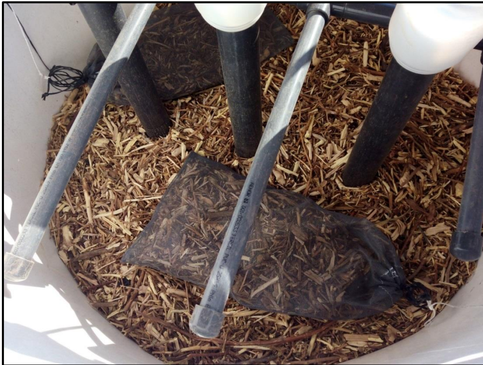
Figura 30. Posición de dos de los cuatros sacos de malla mosquitera con astillas para estudiar la descomposición de la madera en uno de los biorreactores cilíndricos
