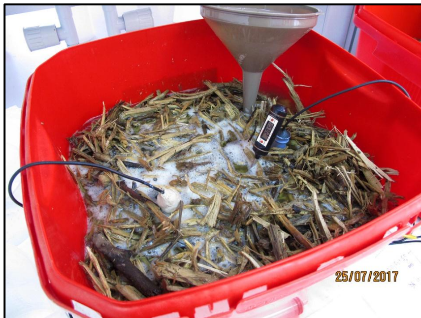
Figura 13. Biorreactor con astillas de cítricos utilizado en los Ensayos 2 y 3. Se aprecia un termómetro digital que se utilizó para medir la temperatura
