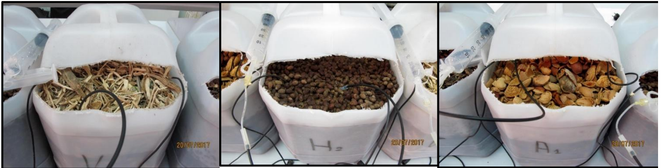
Figura 9. Biorreactor con astillas de cítricos utilizados en el Ensayo 1
