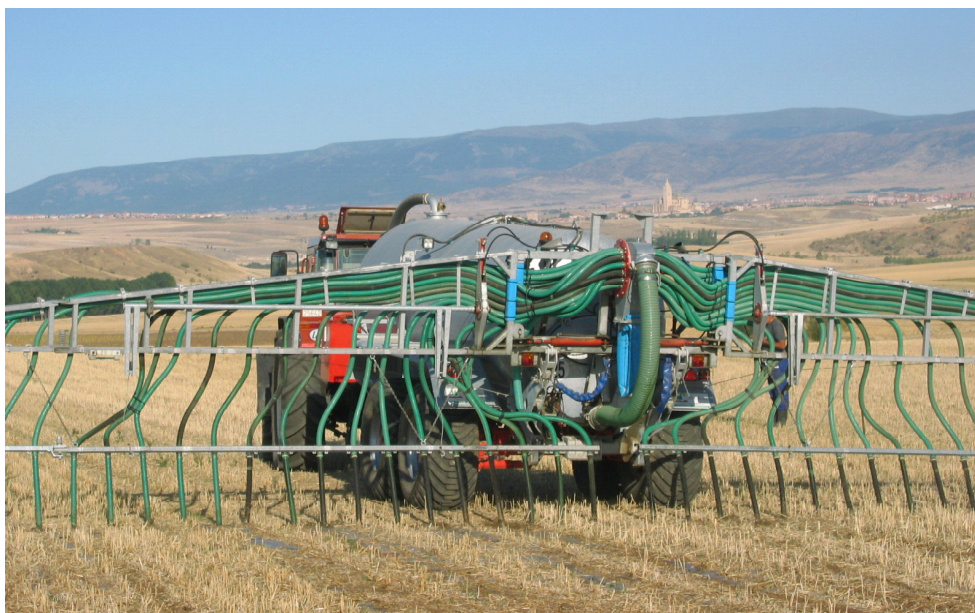
Imagen 10. Sistema de aplicación de purín mediante mangueras
