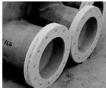
Figura 1. Unión embridada en tubo de PRFV.
