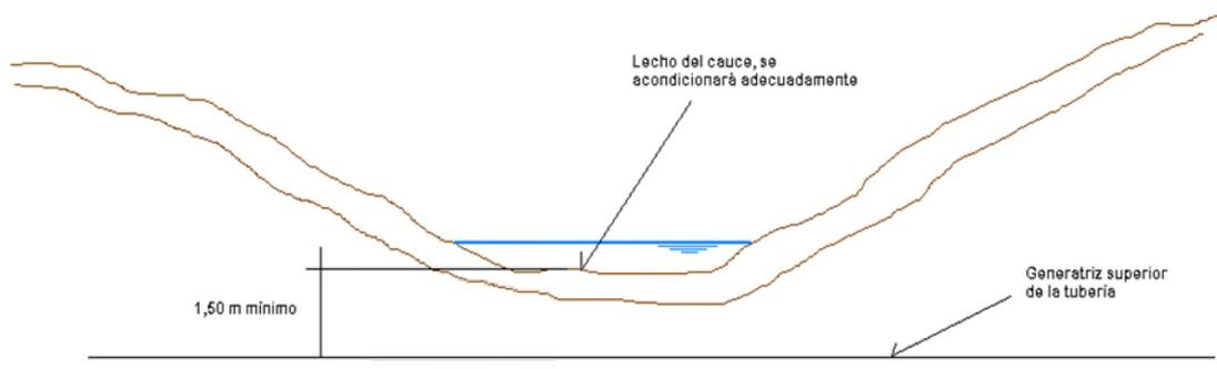
*Imagen 4. Esquema que ejemplifica la distancia mínima que debe dejarse entre la generatriz de la conducción y el lecho del cauce.*
