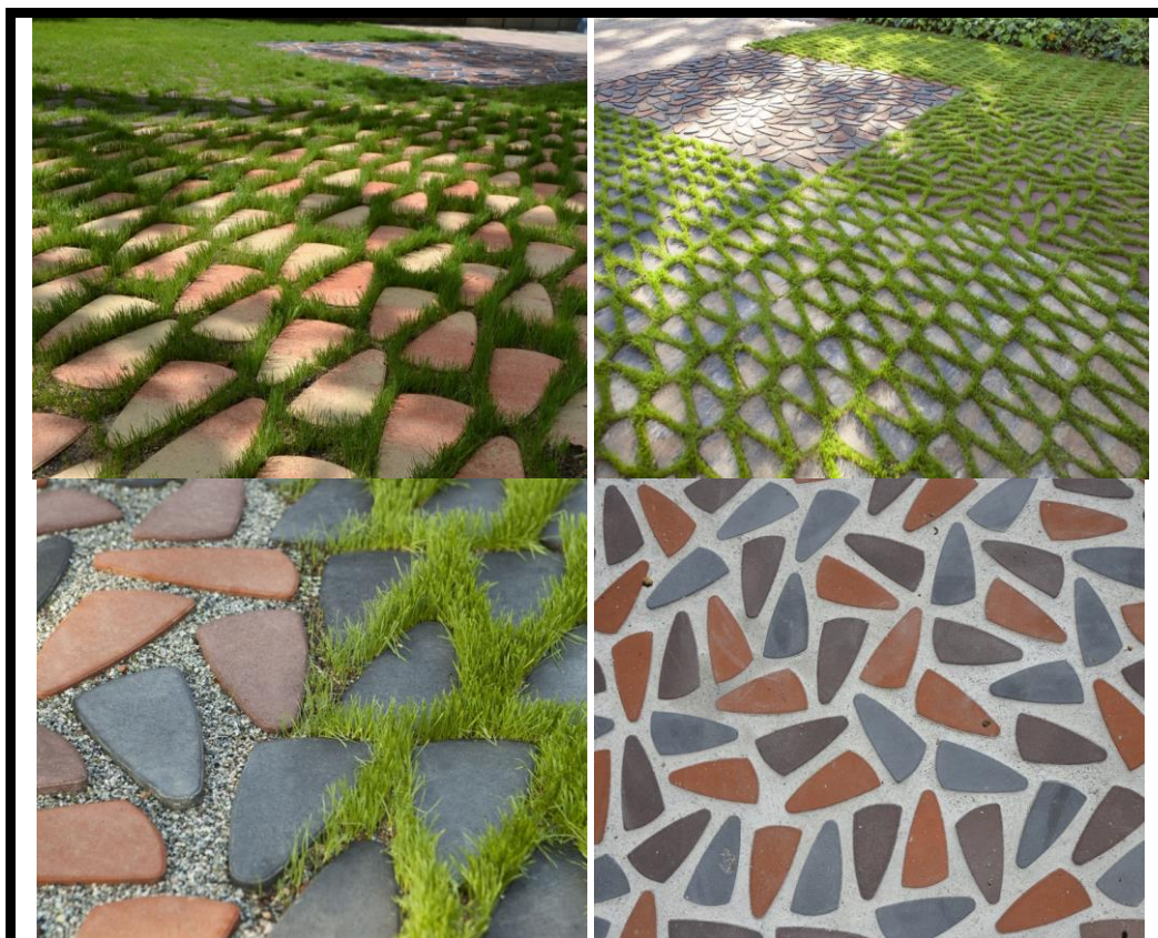
Pavimentos permeables (o drenantes). Pavimento mixto de adoquines en forma de triángulo con junta rellenable. Cortesía de Breinco.
