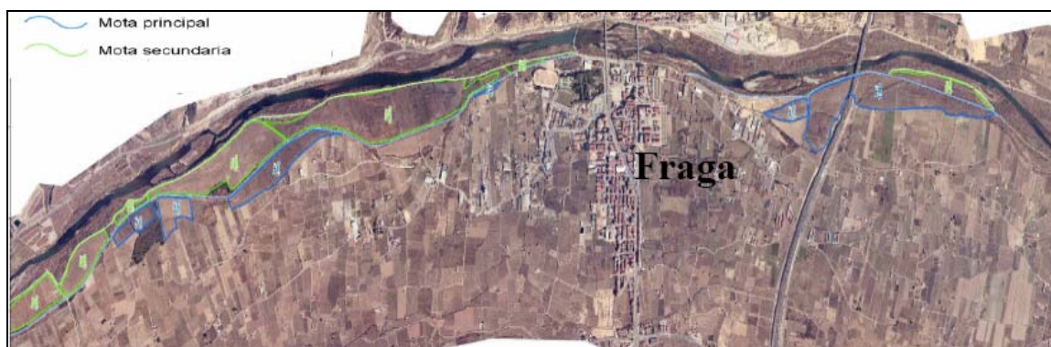
Figura 6: Ubicación de la mota secundaria a eliminar (en verde) (Confederación Hidrográfica del Ebro)
