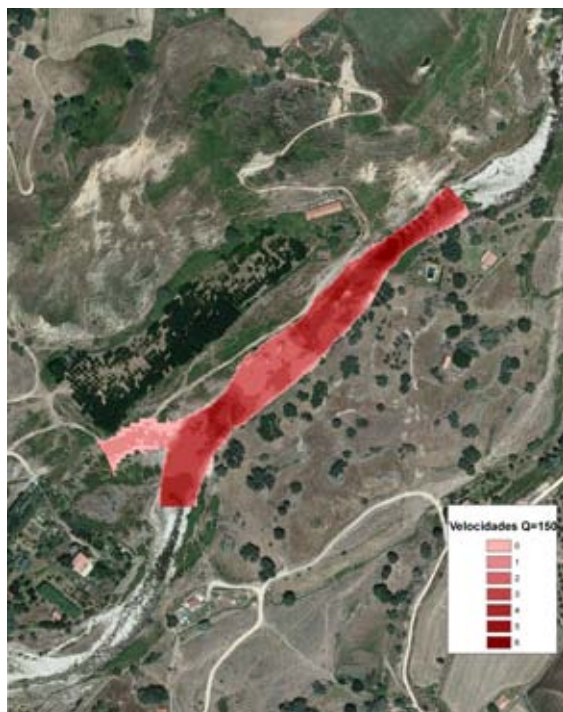
Modelo bidimensional de la velocidad para un caudal de 35 m 3 /s previo a la ejecución. Arroyo de Chilla, t.m. de Candeleda. Elaboración: SERS.
