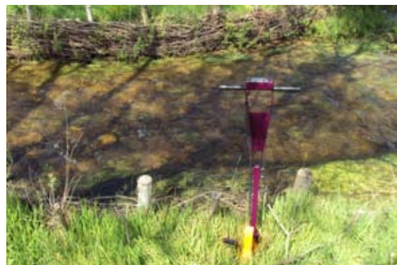
Medición de variables con higrómetro y termómetro junto a fajina.
