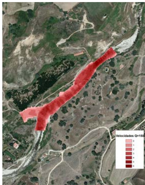
Modelo bidimensional de la velocidad para un caudal de 200 m 3 /s posterior a la ejecución. Arroyo de Chilla, t.m. de Candeleda. Elaboración: SERS.
