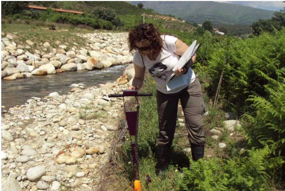
Toma de datos con higrómetro.
