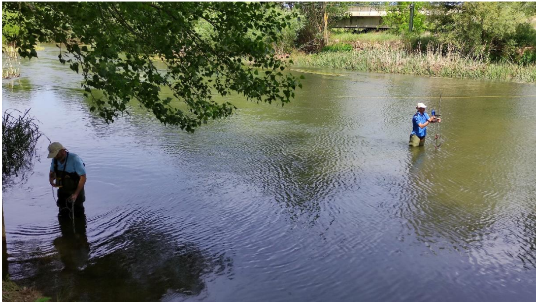
Fotografía 23. Aforo de caudales en una sección natural de río.
