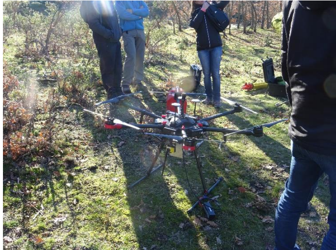
Imagen 16: Dron para la realización del vuelo LiDAR en la RNF Alto Eresma.
