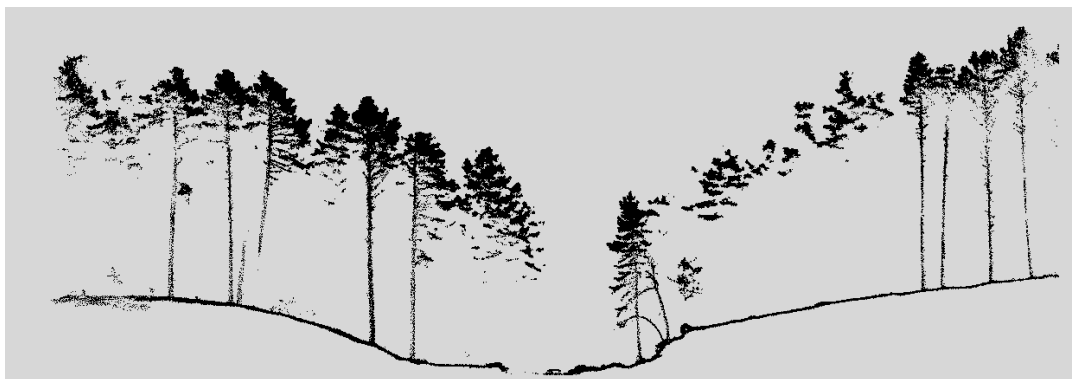
Figura 42: Ejemplo de perfiles de vegetación obtenidos con levantamiento LiDAR de alta densidad de pulsos.
