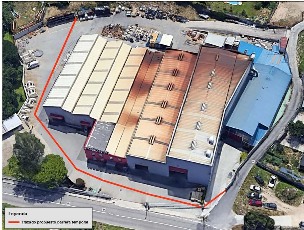
*Ilustración 29. Trazado propuesto para la instalación de las barreras temporales.*
