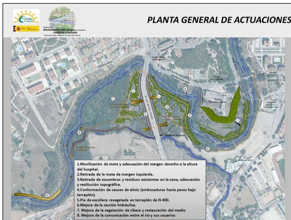
Figura 8. Ejemplo de proyecto de restauración fluvial realizado dentro de los proyectos Plan PIMA Adapta 2018: “Proyecto de disminución del riesgo de inundación y mejora del estado ecológico de los ríos Júcar y Moscas a su paso por Cuenca”. Fuente: Confederación Hidrográfica del Júcar y Ministerio para la Transición Ecológica.
