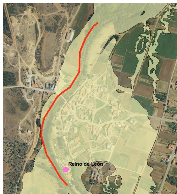
Figura 32.- Camping en la zona inundable de periodo de retorno de 500 años del ARPSI ES020/005_03-1800042-01, de la Demarcación Hidrográfica del Duero
