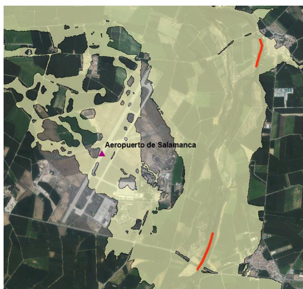
Figura 38.- Afección de la avenida de periodo de retorno de 500 años del río Tormes sobre el aeropuerto de Salamanca (ARPSIs ES020/0025_12-1800004-09 y ES020/0025_12-1800004-08)
