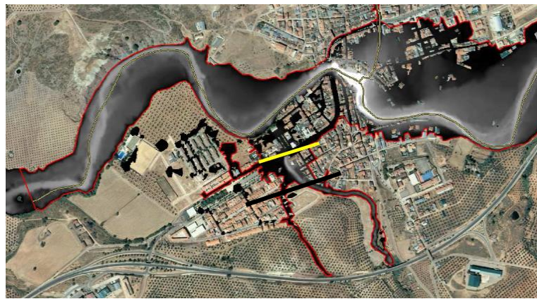
Figura 11.- Mantenimiento de la zona inundable de afluentes con riesgo (incluidos en la modelización) en la delimitación de la zona final
