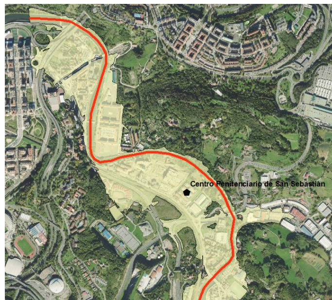
Figura 31.- Detalle de la zona inundable de periodo de retorno de 500 años del ARPSI ES017-GIP-URU-01, en la Demarcación Hidrográfica del Cantábrico Oriental, la cual se encontraría afectando al centro penitenciario de San Sebastián
