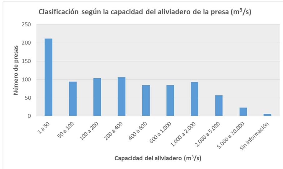
Figura 6. Número de presas según la capacidad de desagüe de sus aliviaderos.
