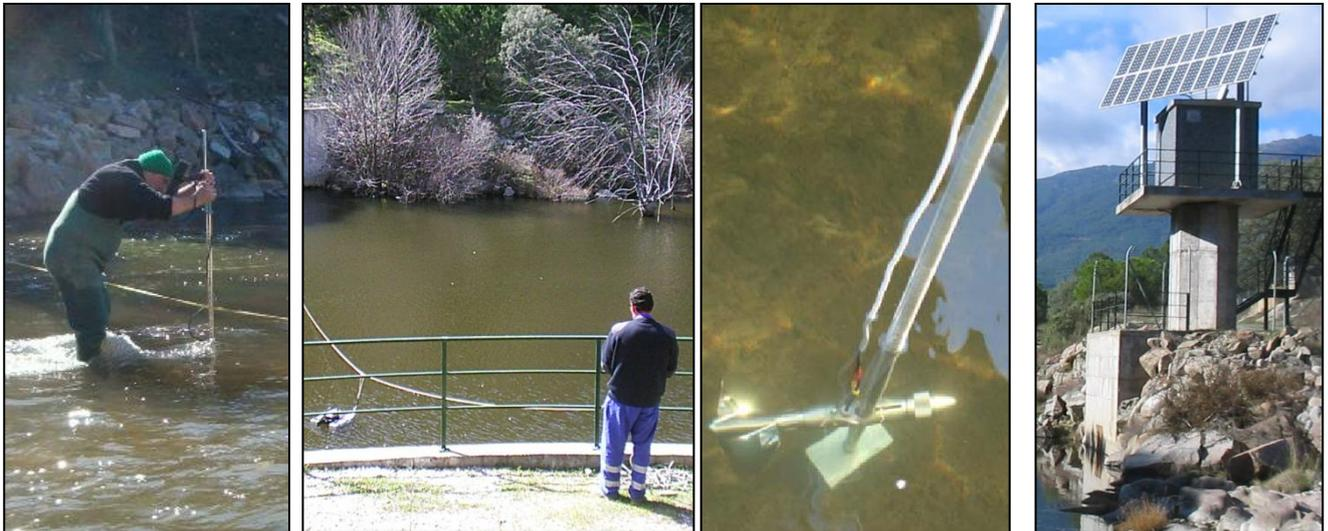
**Ilustración 3: Distintas imágenes de las tecnologías utilizadas en la medida de caudales en ríos, a partir de aforos directos para la calibración de las curvas de gasto y elementos de transmisión de la información hidrológica.**
