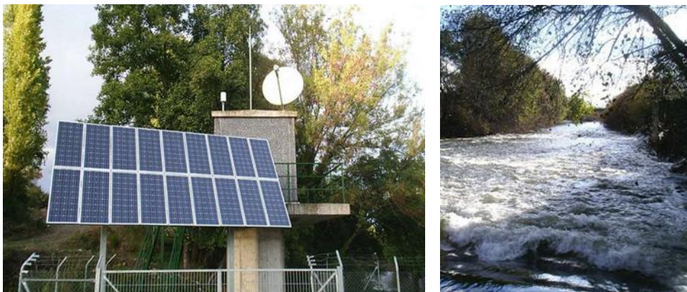
Ilustración 4: Distintas imágenes de una estación de aforos de lectura y transmisión automática de la información hidrológica.
