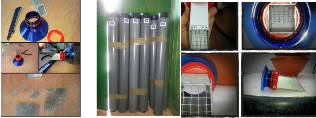
Figura IV.2: Trampa de doble embudo y detalle de fabricación de boca de entrada. Fuente: Proyecto LIFE LAMPROPELTIS
