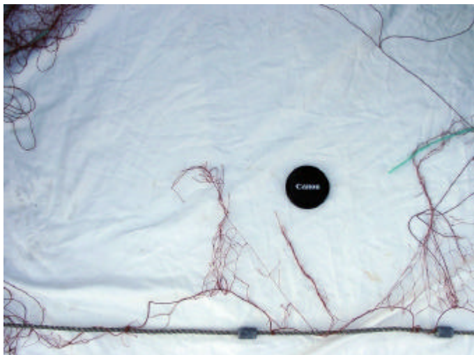
Figura 4.24 Agujero en la parte inferior de la red (se observa la relinga de plomos). Estos agujeros son frecuentes y son atribuidos a la propia actividad de pesca.
