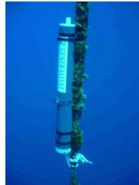
POD instalado en la línea de fondeo de la boya nº 11.
