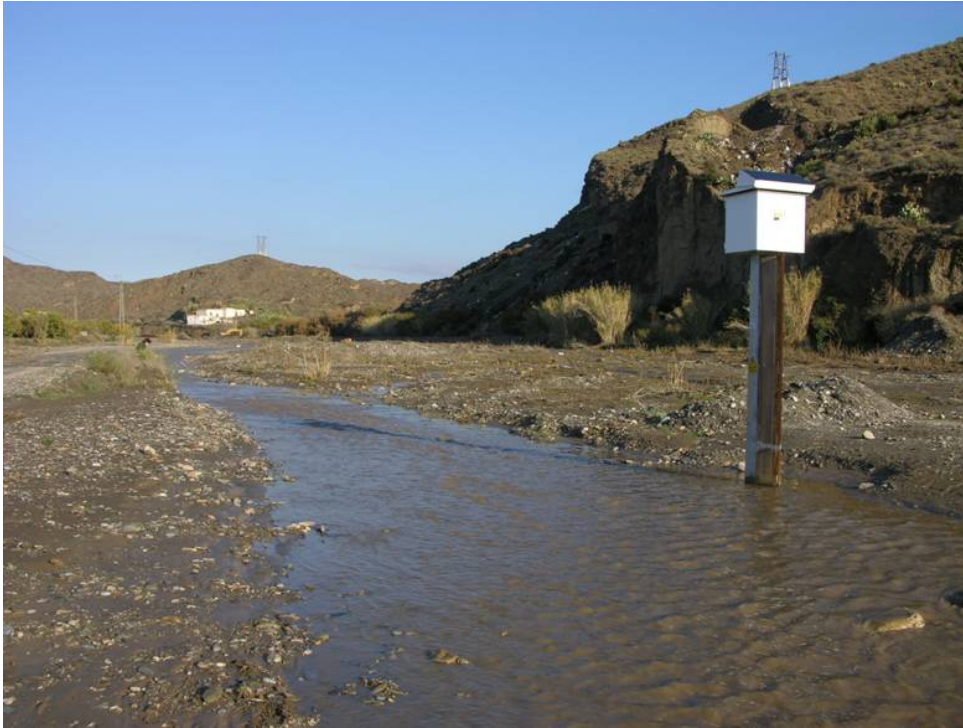
Vista de la estación para la medida de la infiltración del río Andarax en el acuífero aluvial.
