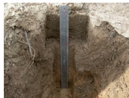
Foto 6. Perfil completo, prisma superior (0-10 cm) y prisma inferior (10-30 cm) para toma de muestras en parcela prácticamente sin pedregosidad, situación poco habitual.
