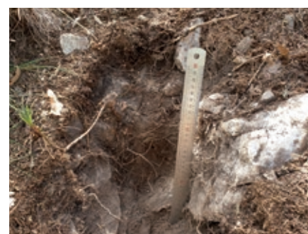
Foto 7. La abundancia de pedregosidad a lo largo del perfil dificulta la realización de los prismas de recogida de muestras.
