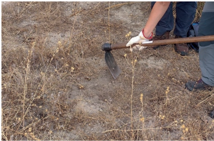
Foto 2. Retirada de restos vegetales del horizonte superficial para apertura de calicata.
