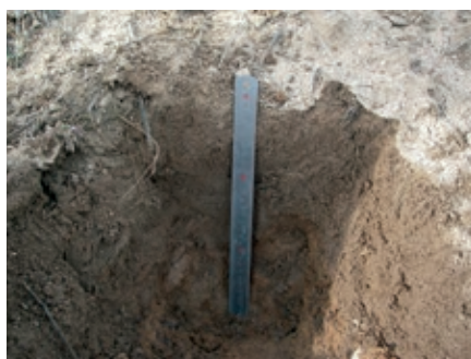
Foto 6. Perfil completo, prisma superior (0-10 cm) y prisma inferior (10-30 cm) para toma de muestras en parcela prácticamente sin pedregosidad, situación poco habitual.
