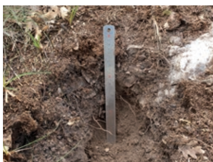
Foto 7. La abundancia de pedregosidad a lo largo del perfil dificulta la realización de los prismas de recogida de muestras.
