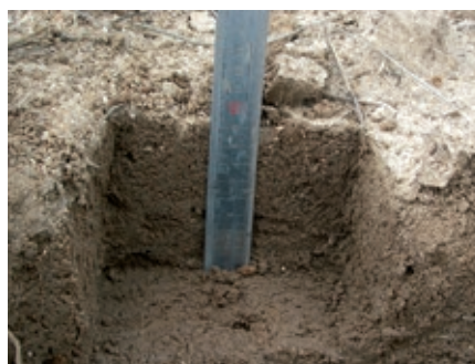
Foto 6. Perfil completo, prisma superior (0-10 cm) y prisma inferior (10-30 cm) para toma de muestras en parcela prácticamente sin pedregosidad, situación poco habitual.
