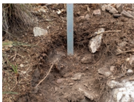
Foto 7. La abundancia de pedregosidad a lo largo del perfil dificulta la realización de los prismas de recogida de muestras.
