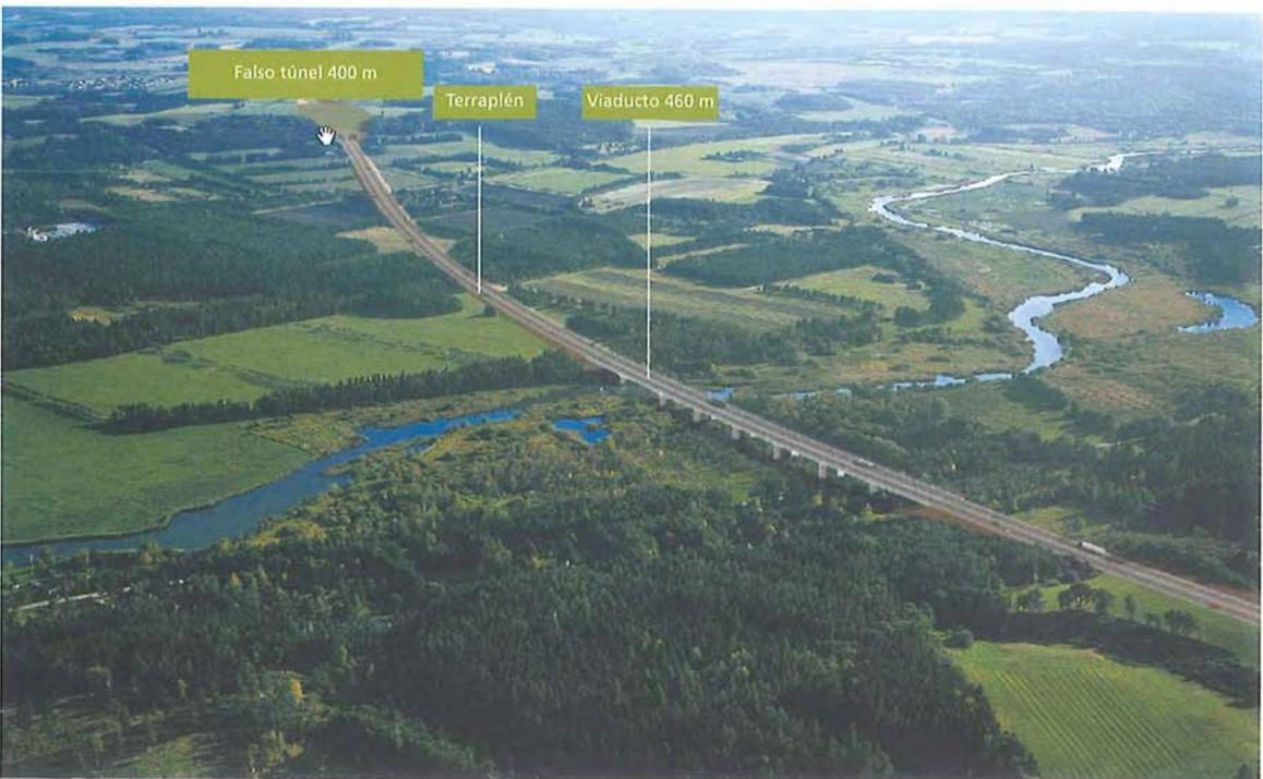
Figura 5.6 y 5.7 – Visualizaciones informáticas que muestran opciones alternativas para el trazado de un viaducto que cruza el río Gudenaå, en Dinamarca. (Dirección General de Carreteras de Dinamarca: VVM Motorvejen Herning-Århus ved Silkeborg)
