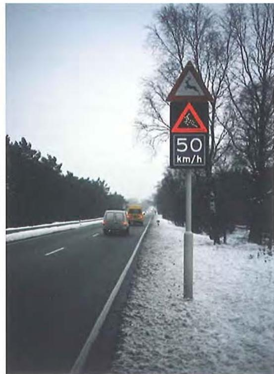
Figura 7.86 – Sistema de aviso con sensores térmicos utilizado en Suiza, en un tramo en el que los ciervos acostumbran a cruzar la carretera. (Foto de H. Bekker)
