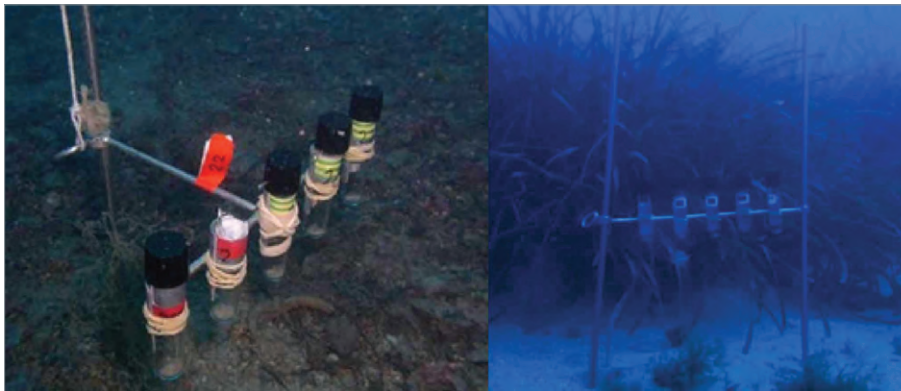
Figura 3.12 Trampas de sedimento bentónicas instaladas en el campo.
