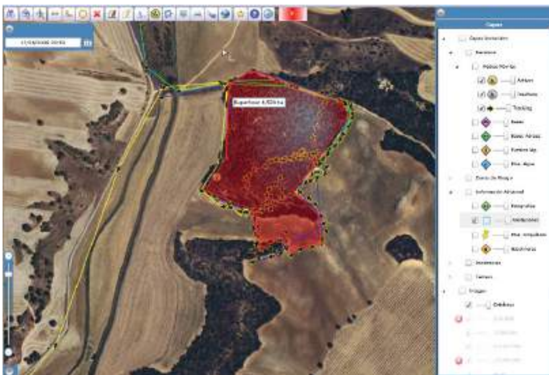
Perimetración y tracks de los equipos durante la ejecución de sus tareas sobre plataforma EMERCARTO. Dispositivos localizadores mediante GPS Bluetooth y telefonía GSM.
