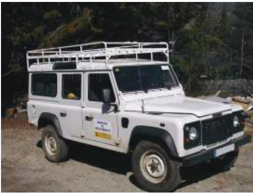
Vehículo todo terreno con baca adaptada y vehículo todoterreno tipo pickup con cajón cerrado para transporte y almacenaje de herramientas.
