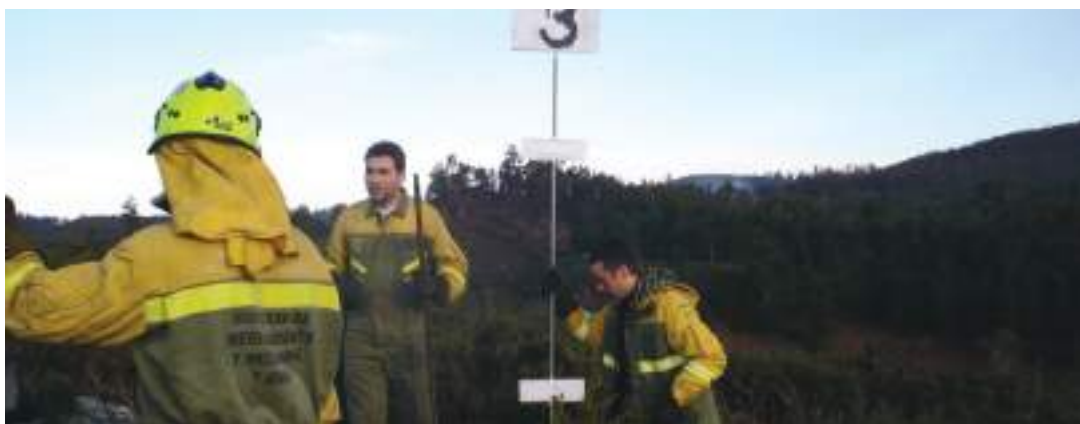
Colocación de un jalón en la parcela de quema, quedando al aire 2,5 m.
