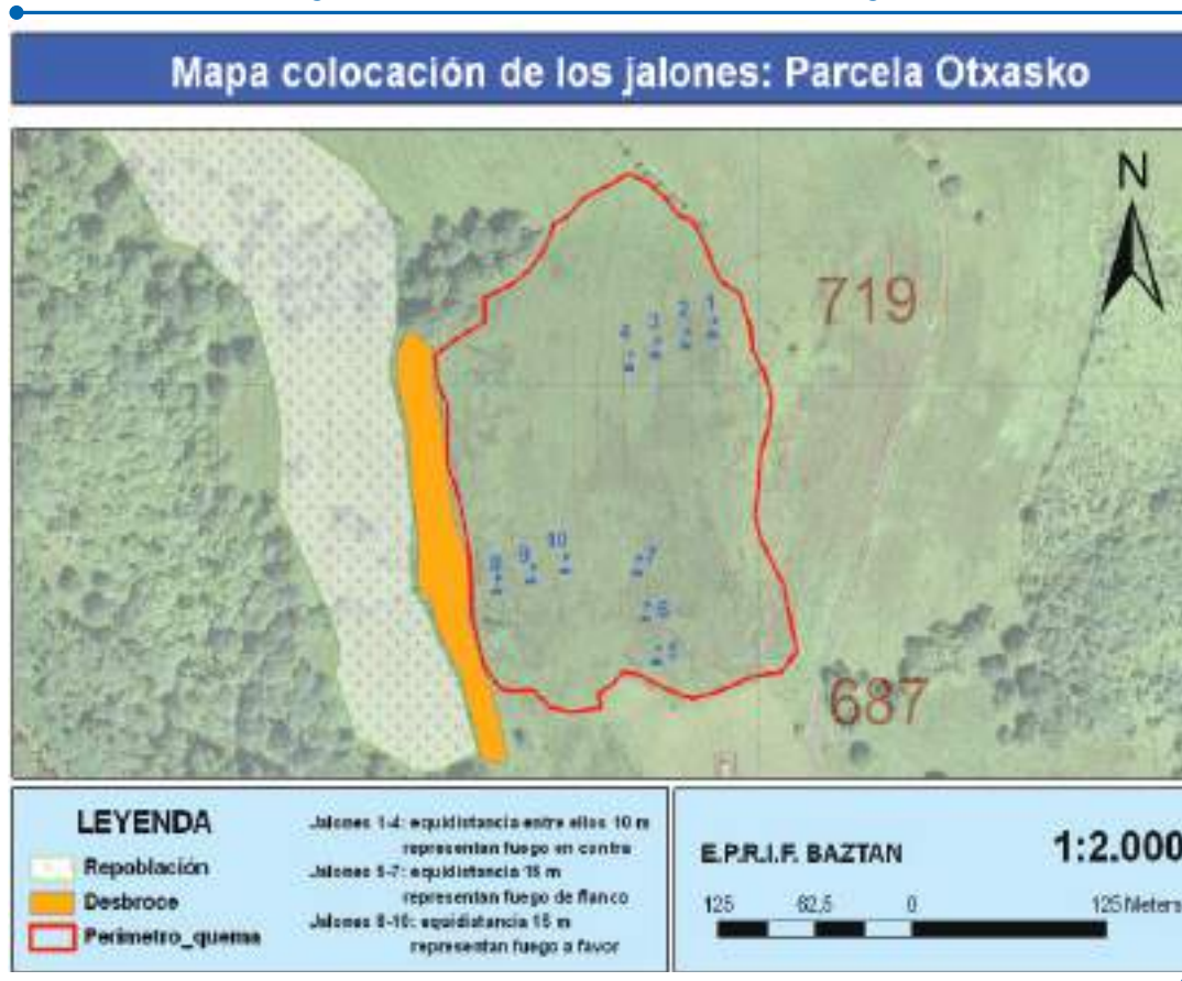
Figura 92. Detalle de la colocación de los testigos.
