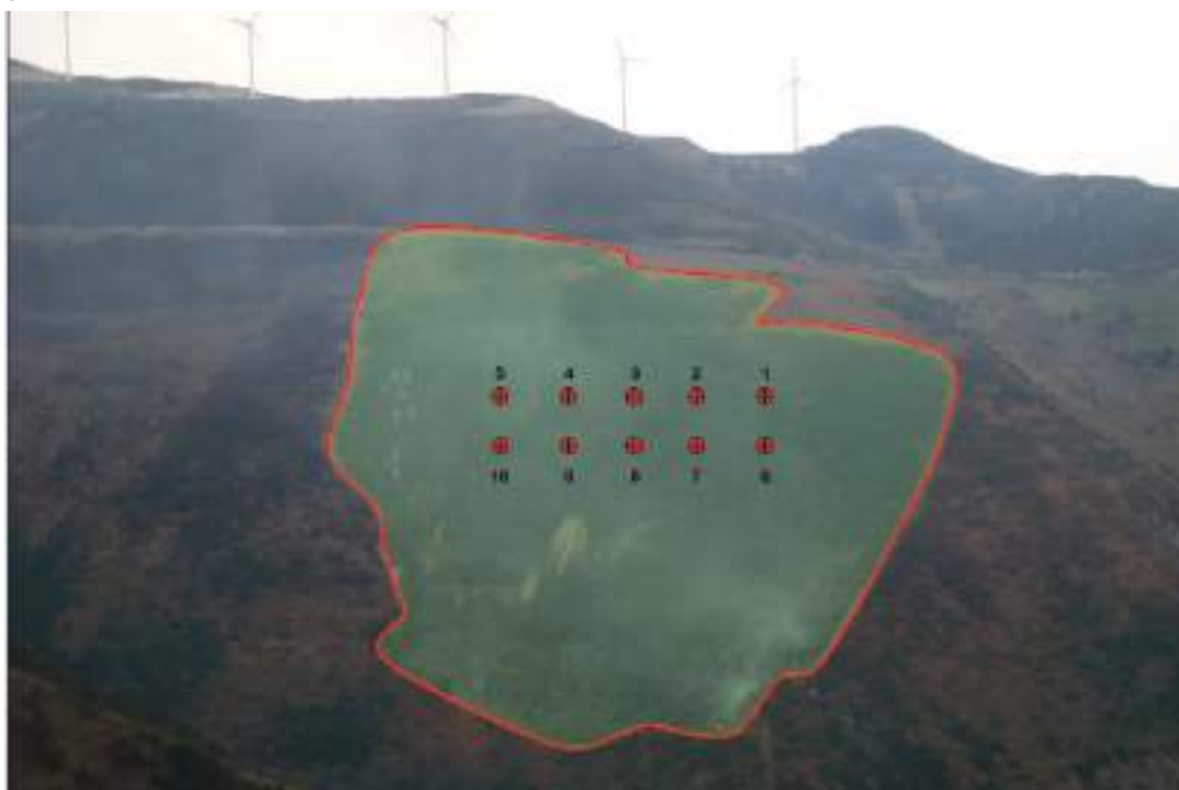
Figura 5: Ubicación de jalones para estimación de altura de la llama y velocidad de propagación.
