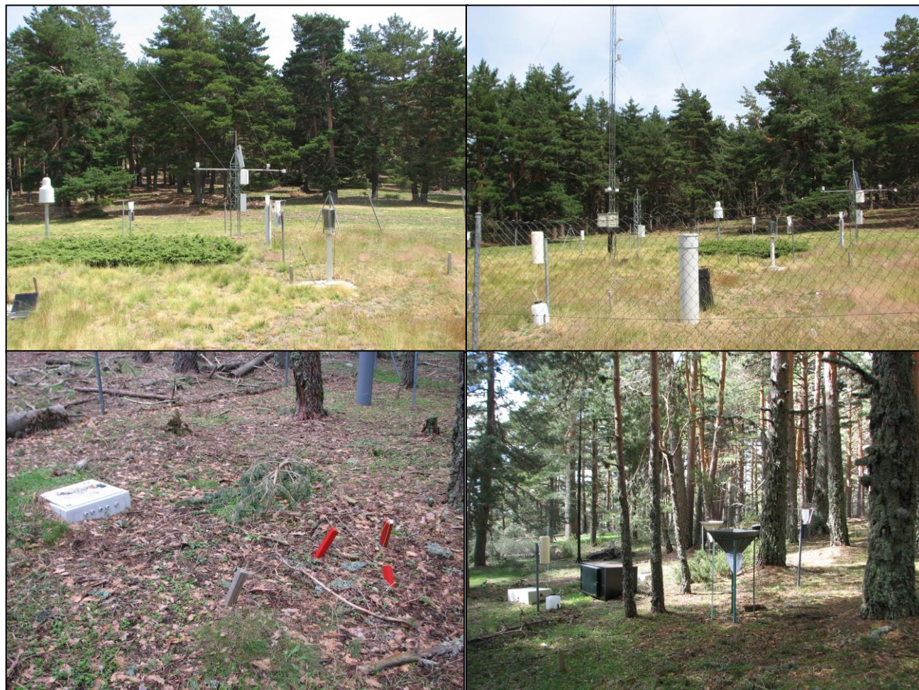
FIG 7: Parcela exterior. Pluviómetros, captadores e instrumentación meteorológica. Parcela interior. Lisímetros, sondas de humedad, captadores de desfronde y acumuladores.
