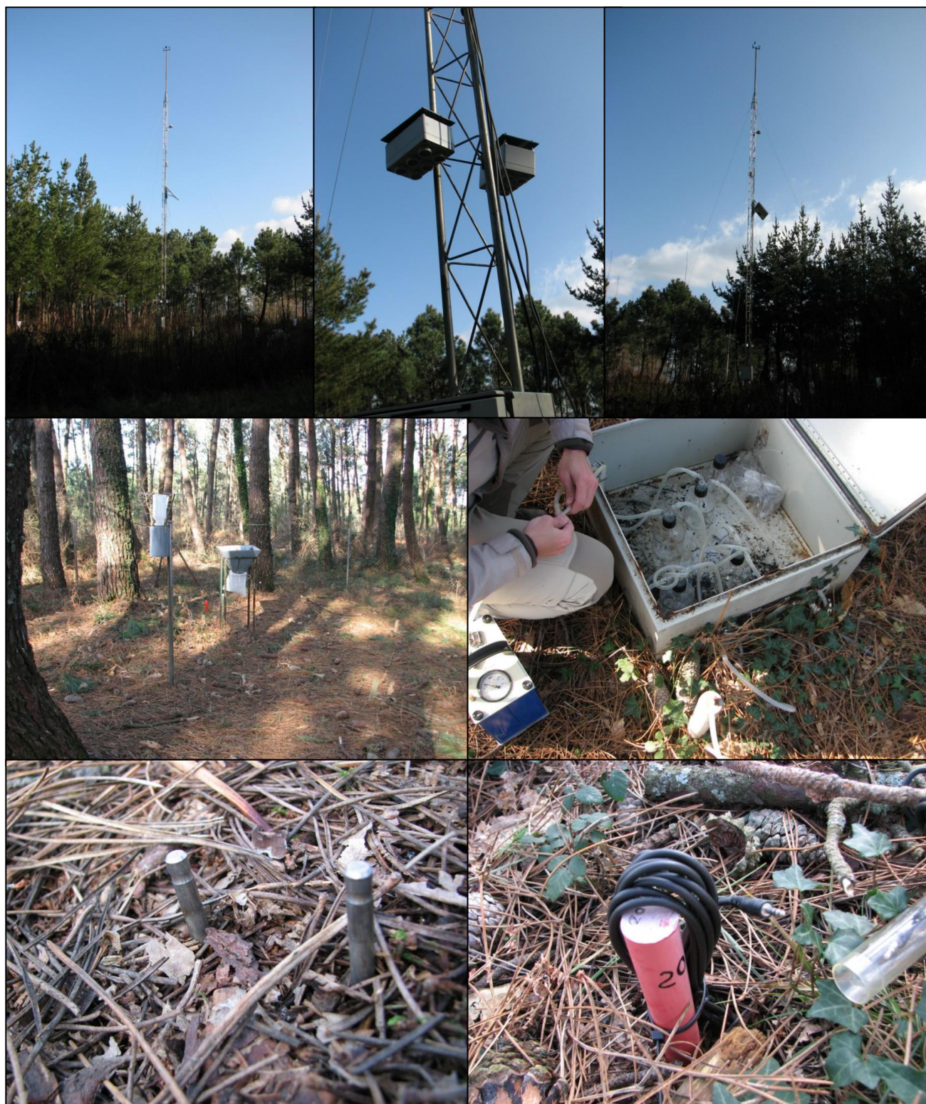
FIG 7: Parcela exterior, torre meteorológica y dosímetros. Parcela interior, captadores. Caja de lisímetros. Sondas de humedad
