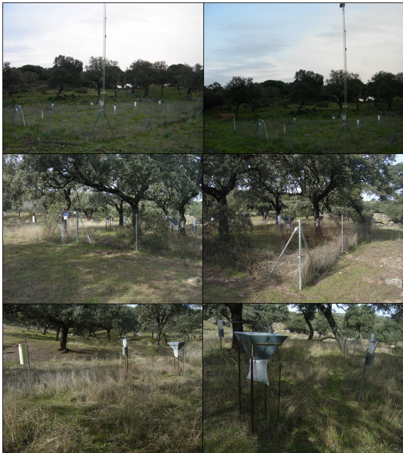
FIG 7 : Parcela exterior. Instrumentación y acumuladores. Parcela interior. Vista general, acumuladores, pluviómetro y captador de desfronde.
